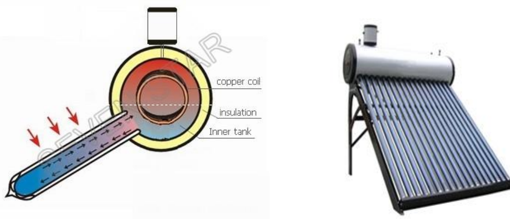
56. ábra Indirekt kompakt vízmelegítő [30]
