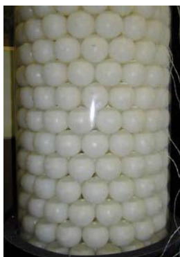
67. ábra Kísérleti látens hőtároló, makrokapszulákba zárt PCM (paraffin) [33]
