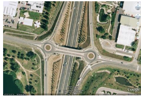
4.6.15. és 4.6.16. ábra Körforgalmú rész-csomópontok külön szintű csomópontokban [4]
