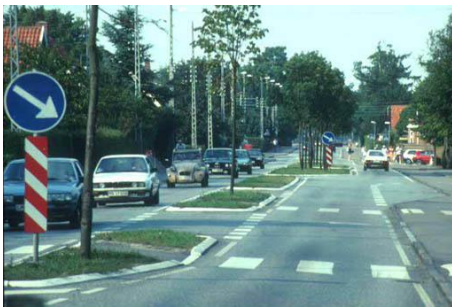
4.2.10. ábra Visszaépítés zöldsávval
