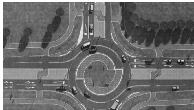
4.6.8. ábra Turbó körforgalom kialakítása Hollandiában (Fotó: Royal Haskoning, 2009) [3]
