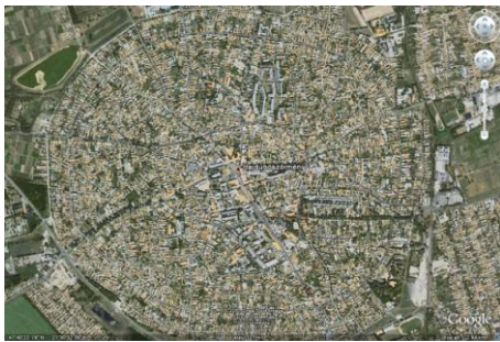
2.2.8. ábra Példa halmazszerű úthálózat szerkezetre [6]
