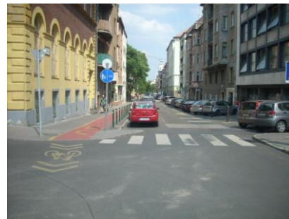
3.1.8. ábra Elválasztott gyalog- és egyirányú kerékpárút, egyirányú útpályán azonos irányú kerékpáros nyom
