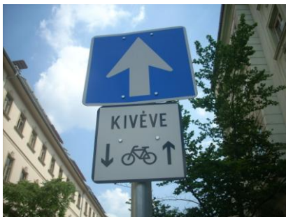
3.1.9. ábra Egyirányú utcában megengedett kétirányú kerékpáros haladás táblázása
