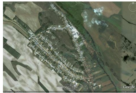
2.2.9. ábra Példa lineáris úthálózat szerkezetre [6]
