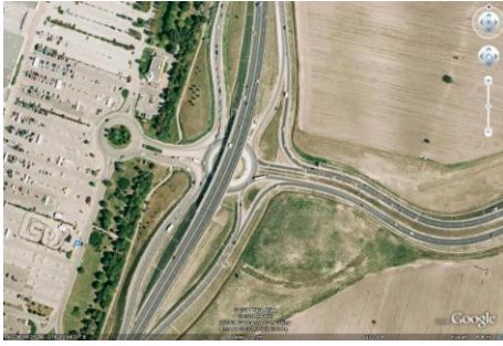
4.6.15. és 4.6.16. ábra Körforgalmú rész-csomópontok külön szintű csomópontokban [4]
