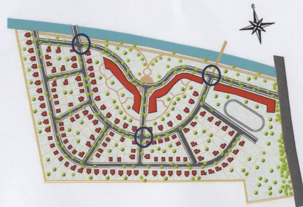
Felaszfaltozott küszöbök ajánlott elhelyezkedése
