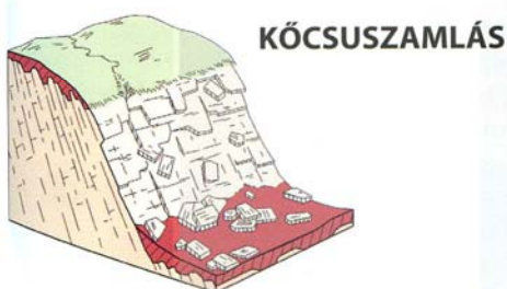
KŐCSUZAMLÁS Kőzetdarabok gyors lecsúszása egy rétegzési vagy tektonikai síknak megfelelően.
