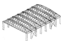
(d) Oszlopokra támaszkodó íkerívek rendszere
