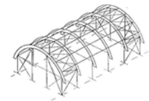
(b) Oszlopokra támaszkodó, íves főtartó rendszer
