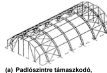
(a) Padlósíntre támaszkodó, íves főtartó rendszer
