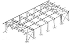
(b) Keretfőtartós, szelemenes rendszer
