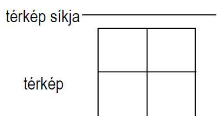
b) a képsík dőlt helyzetű, a terepsík párhuzamos a térképezés síkjával: képdőlésből származó perspektív torzulás
