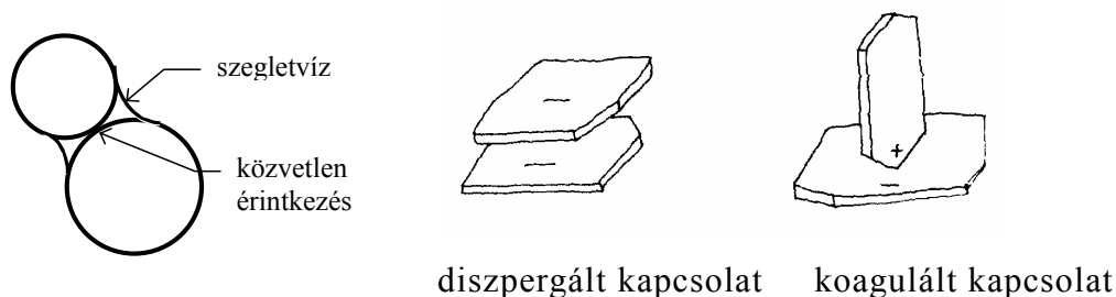
2.4. ábra. A homok- illetve az agyagszemcsék kapcsolata.
