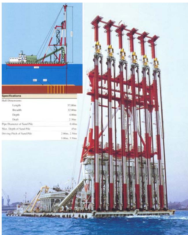
47. ábra. Összekapcsolt vibrátorokkal végzett tömörítési eljárás. Japán –Osaka repülőtér építése.
