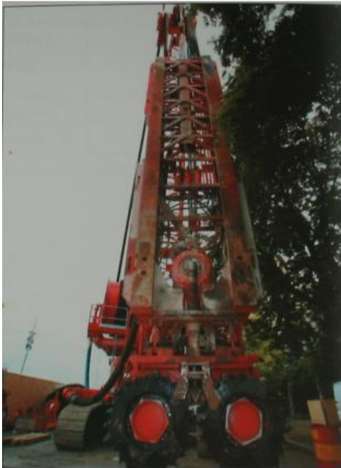
83. ábra: A hidrofrezér marótárcsás vezérgép és marótárcsák.
