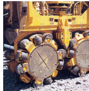
83. ábra: A hidrofrezér marótárcsás vezérgép és marótárcsák.
