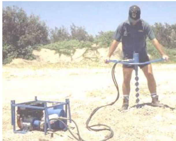
4. ábra: Kézi, motoros fúróberendezés vázlata
