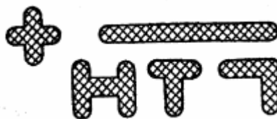
82. ábra: Réspillérek keresztmetszeti kialakítása
