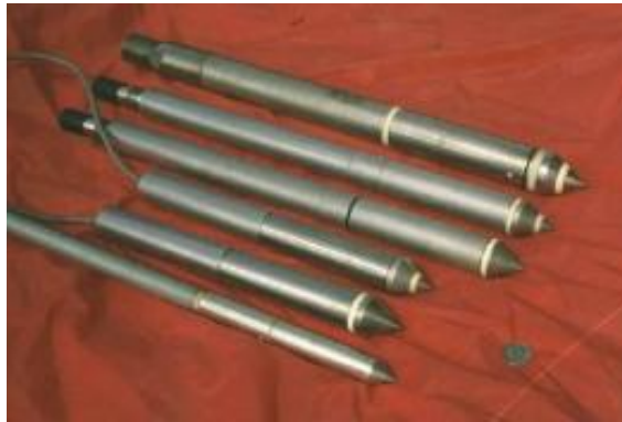
10. ábra: A statikus szonda csúcsa
