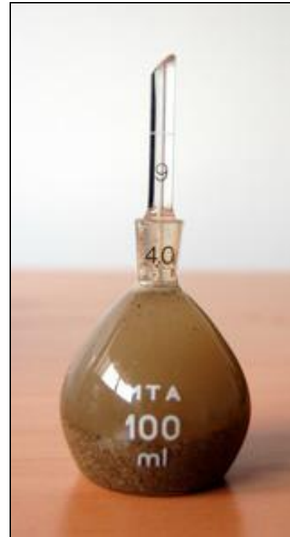
m_3 piknométer + pórusmentes szilárd anyag + anyag feletti folyadék tömege
