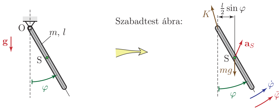
2.10. ábra. Egyszerű fizikai inga és szabadtest ábrája.
