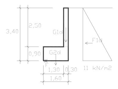
A szerkezetre az állékonyságát veszélyeztető (destabilizáló) és azt biztosító (stabilizáló) hatások működnek.
