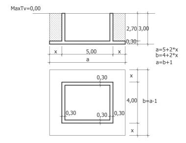
A szerkezetre az állékonyságát veszélyeztető (destabilizáló) és azt biztosító (stabilizáló) hatások működnek.
