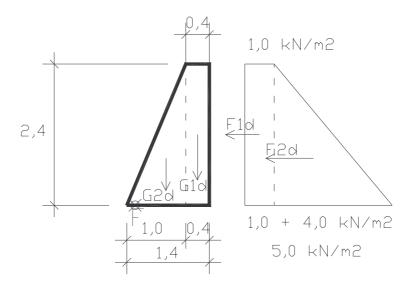
A szerkezetre az állékonyságát veszélyeztető (destabilizáló) és azt biztosító (stabilizáló) hatások működnek.
