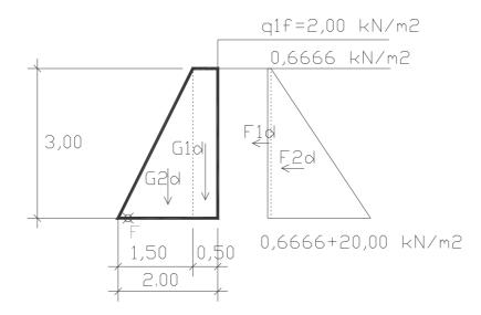
A szerkezetre az állékonyságát veszélyeztető (destabilizáló) és azt biztosító (stabilizáló) hatások működnek.
