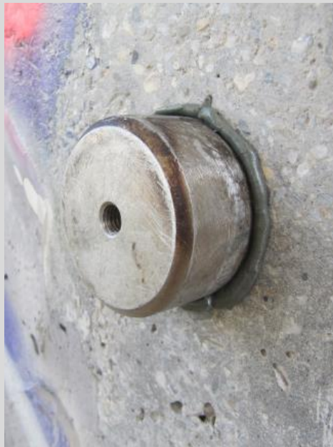
A betonszerkezetek tapadó szilárdságának meghatározása
