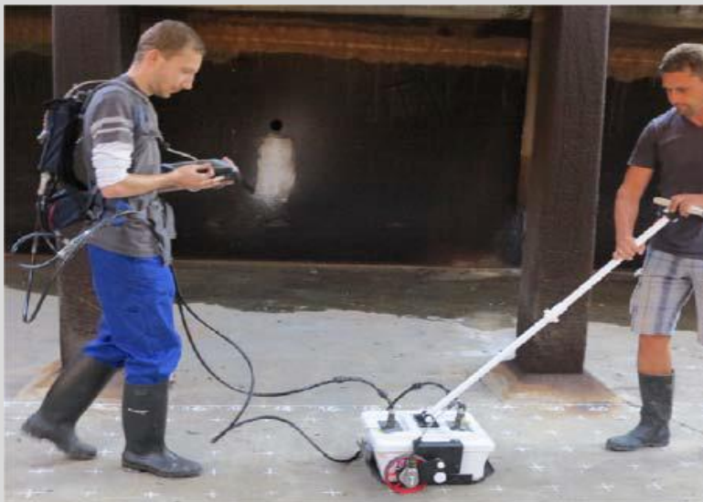
Radarvizsgálatok az alaplemezen és a oldalfalon
