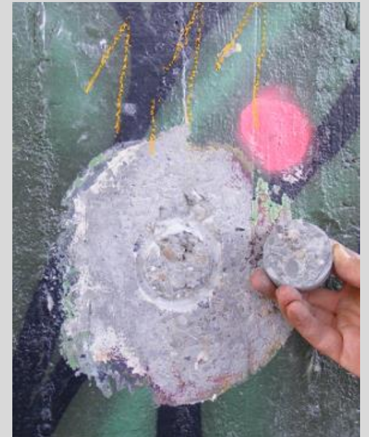
A betonszerkezetek tapadó szilárdságának meghatározása
