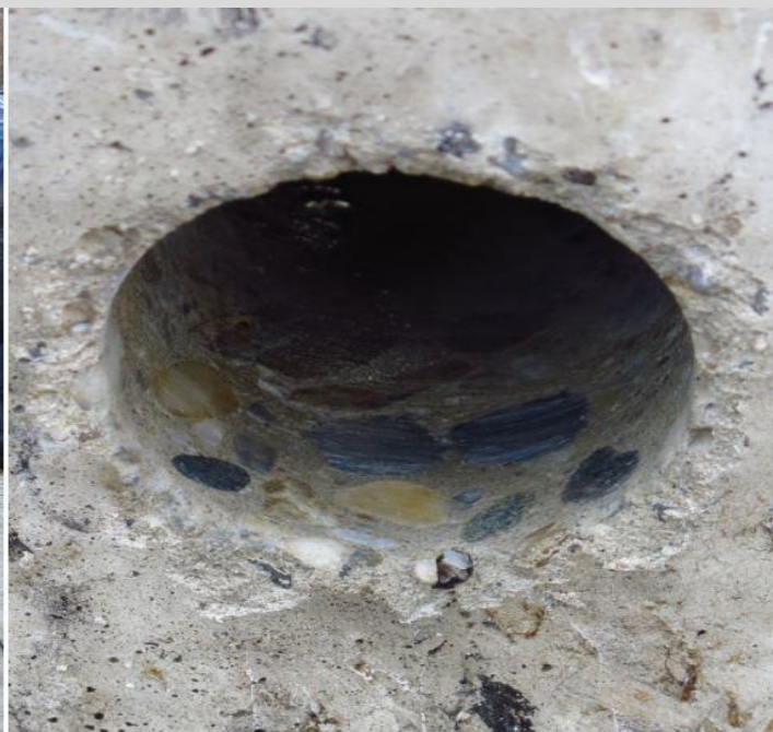
Furatminta vétel a vasbeton siló támfalszerkezetéből
