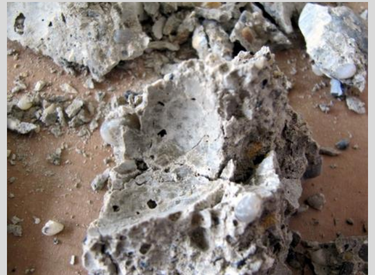
A betonaljzatból kifúrt hengerminta töretfelülete
