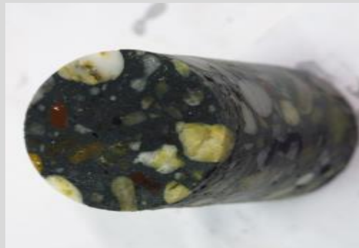
A jó állapotban lévő tömörbeton próbatest
