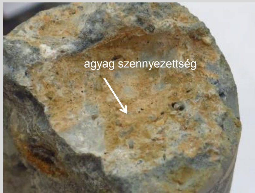
A fúrás közben széttöredezett hengerminta
