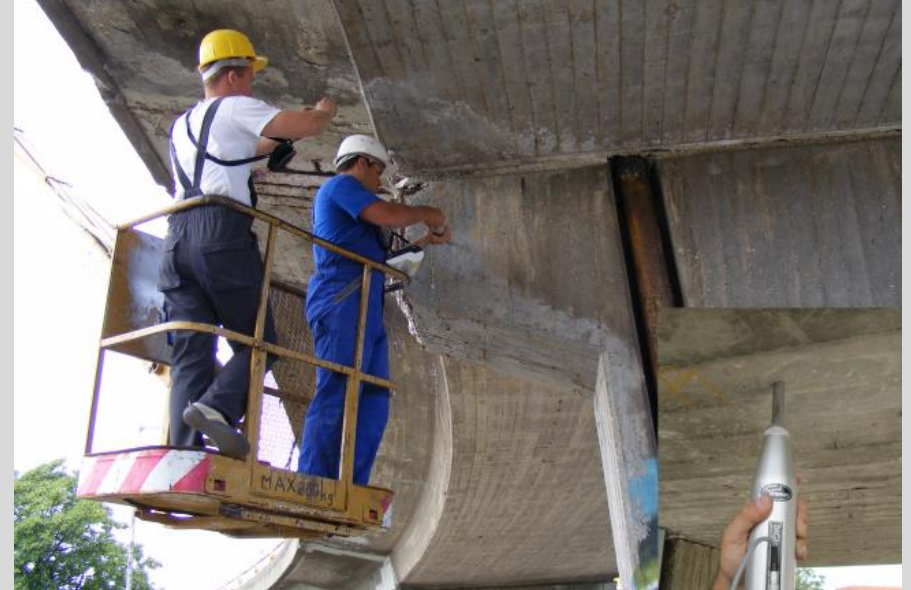
A betonszerkezetek roncsolás mentes szilárdságvizsgálata
