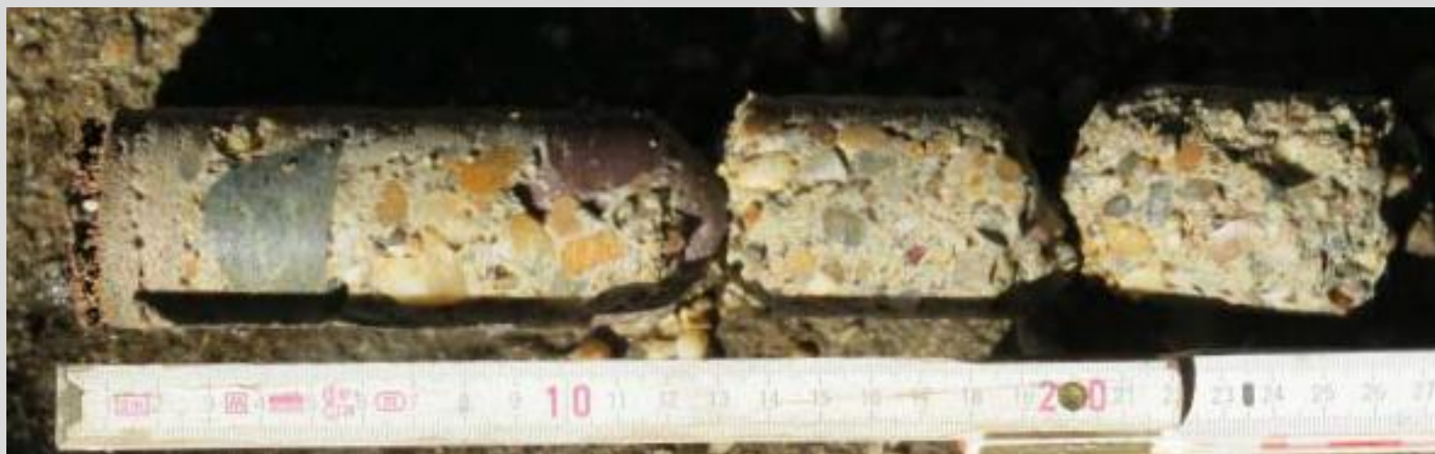
6. sz. A medence oldalfalából kifúrt töredezett magminta
