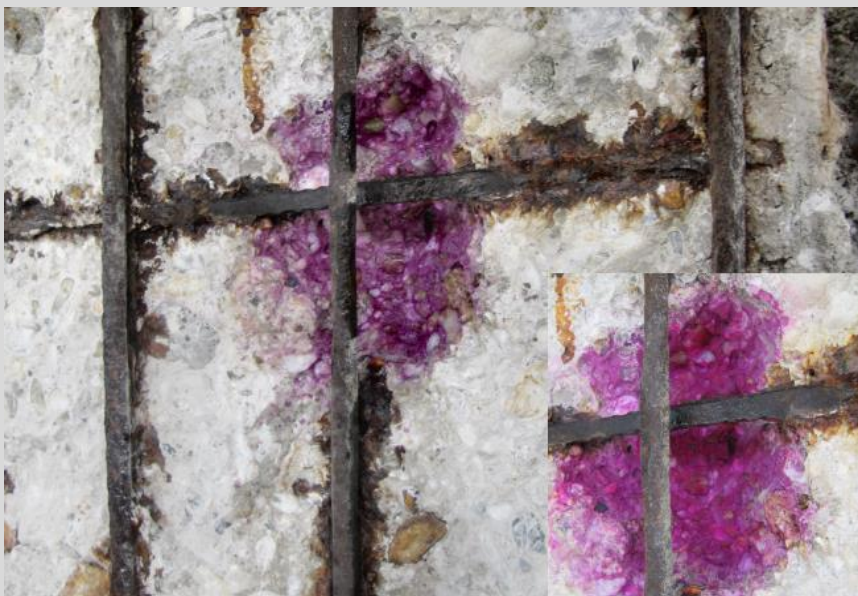
A beton és betonacél korróziós károsodásának vizsgálata
