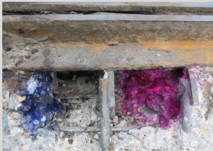
A beton és betonacél korróziós károsodásának vizsgálata
