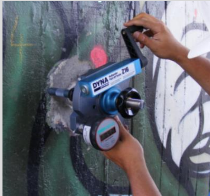
A betonszerkezetek tapadó szilárdságának meghatározása
