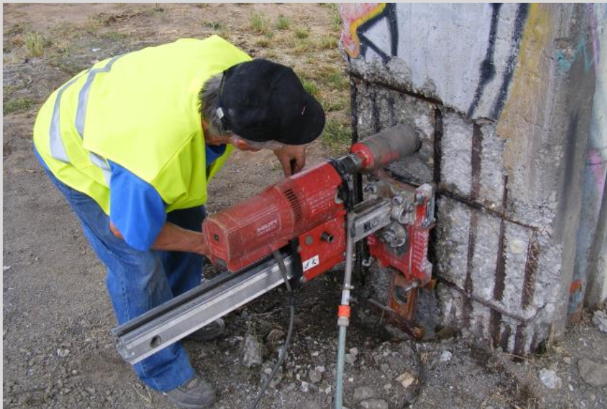
A alaptest feltárása és tartópillérek szilárdságvizsgálata
