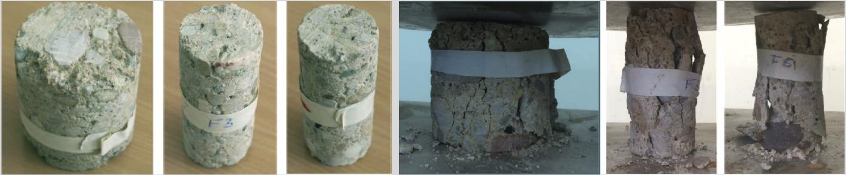
A kifúrt henger próbatestek törés előtt és után
