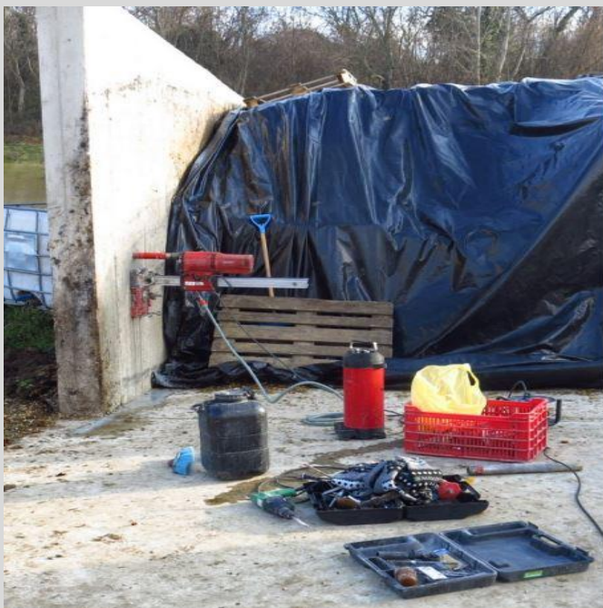
Furatminta vétel a vasbeton siló támfalszerkezetéből
