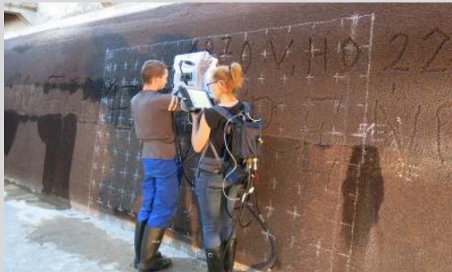
Radarvizsgálatok az alaplemezen és a oldalfalon
