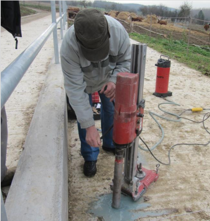
Henger minták kifúrása a betonlemezből
