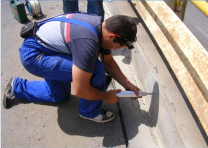
A betonszerkezetek roncsolás mentes szilárdságvizsgálata
