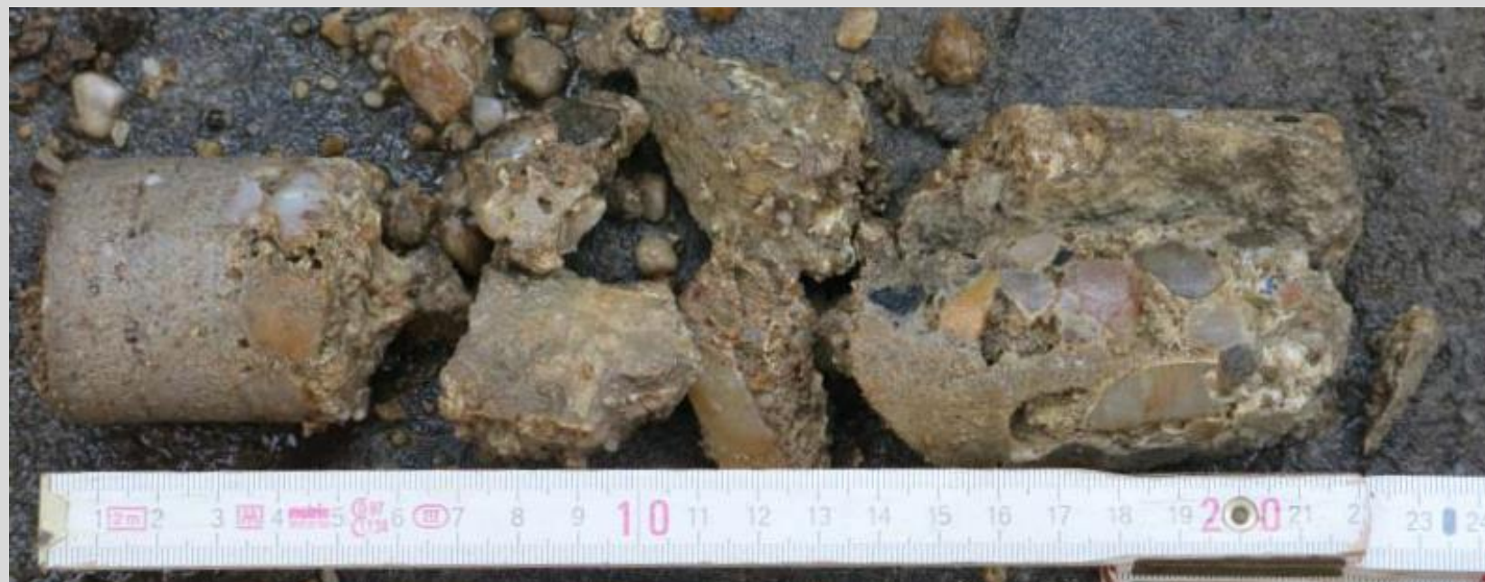
4. sz. A medence oldalfalából kifúrt töredezett magminta
