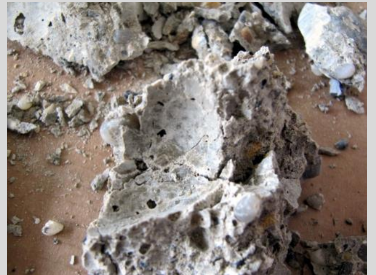
A betonaljzatból kifúrt hengerminta töretfelülete
