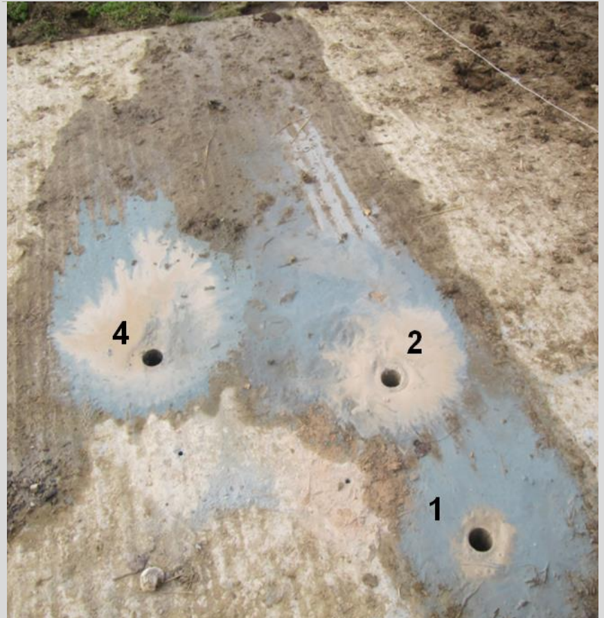
Henger minták kifúrása a betonlemezből
