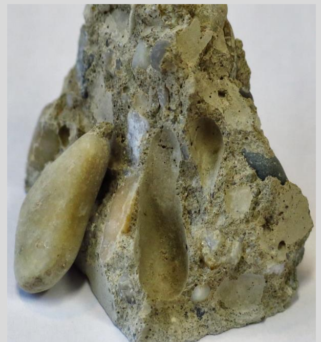
A beton töretképe a kavicszemcsék lenyomataival
