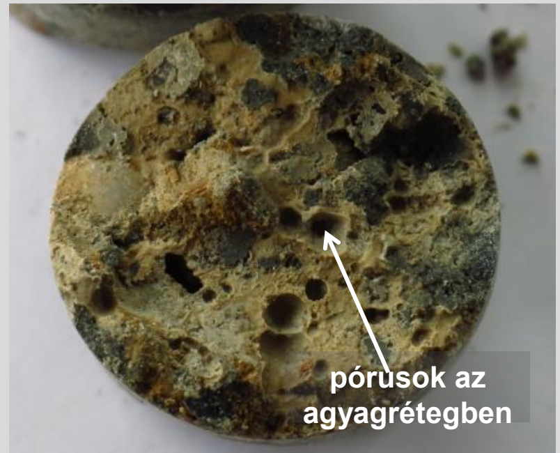
A Visnyeai silótároló betonaljzatából vett furatminta és töretképe
