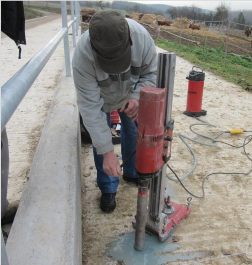
Henger minták kifúrása a betonlemezből
