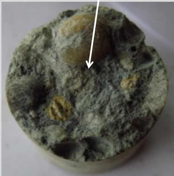
A Visnyei silótároló betonajzatából vett furatminta és töretfelülete
