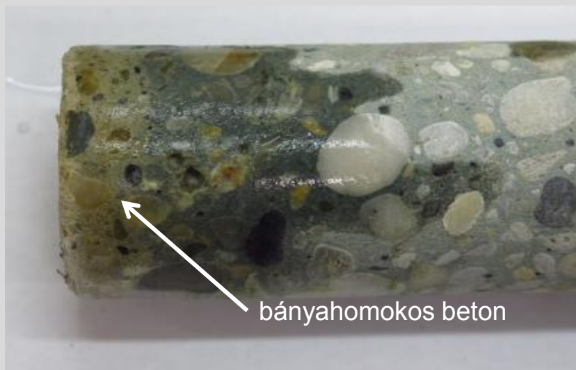
A beton sárga elszíneződése a bányahomok agyagtartalmától
