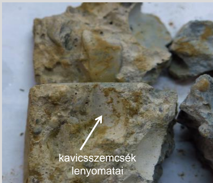
A fúrás közben széttöredezett hengerminta
