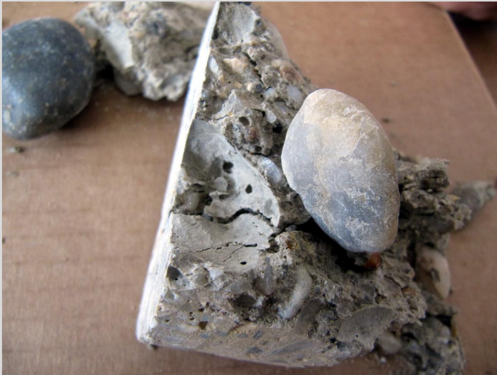
A betonaljzatból kifúrt hengerminta töretfelülete
