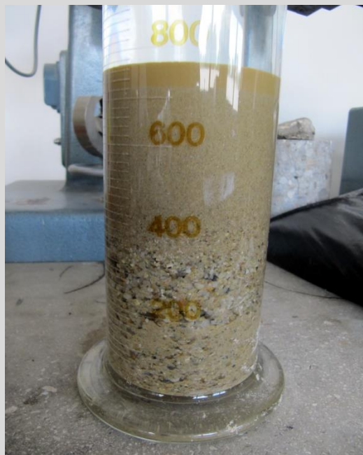
Az alkalmazott homok agyag-iszap tartalmának vizsgálata ( i = 6,4\% )
