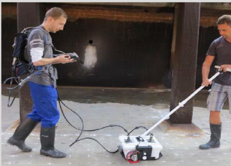
Radarvizsgálatok az alaplemezen és a oldalfalon
