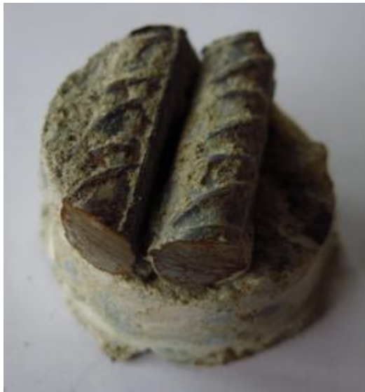
Nem megfelelő tapadás a betonacél és a beton között
