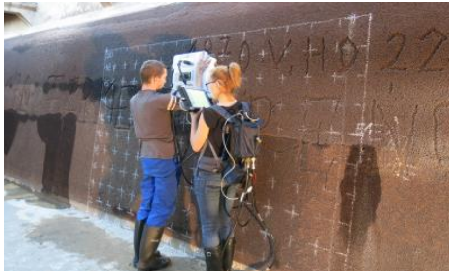
Radarvizsgálatok az alaplemezen és a oldalfalon
