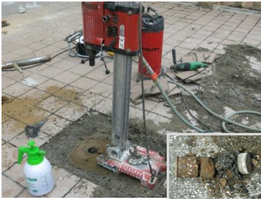
A bauxitbeton szerkezetek vizsgálata (mintavételezés és rétegrend)
