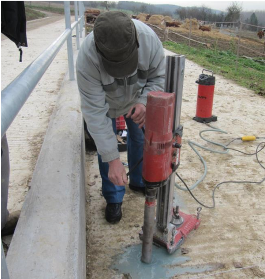
Henger minták kifúrása a betonlemezről
