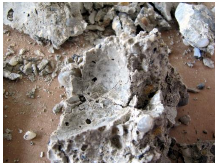
A betonaljzatból kifúrt hengerminta töretfelülete
