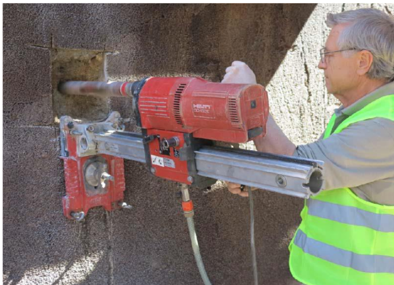
Hengerminták kifúrása az oldalfalból és az alaplemezéből
