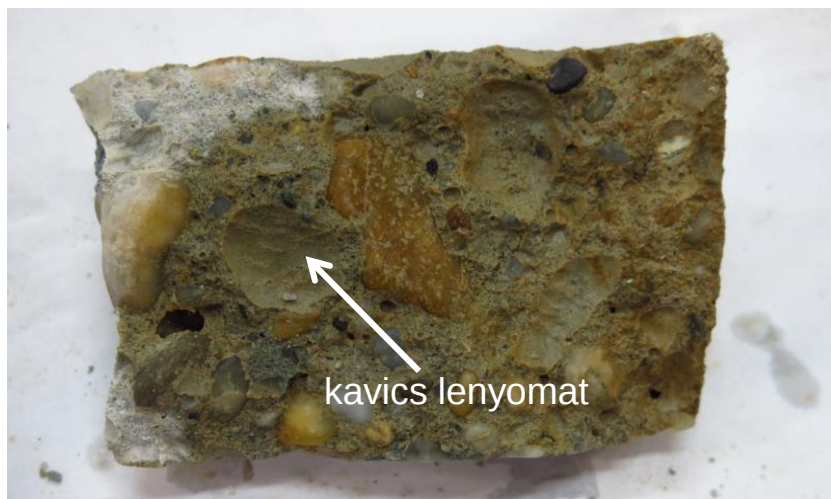
A fúrás közben széttöredezett agyagos hengerminta
