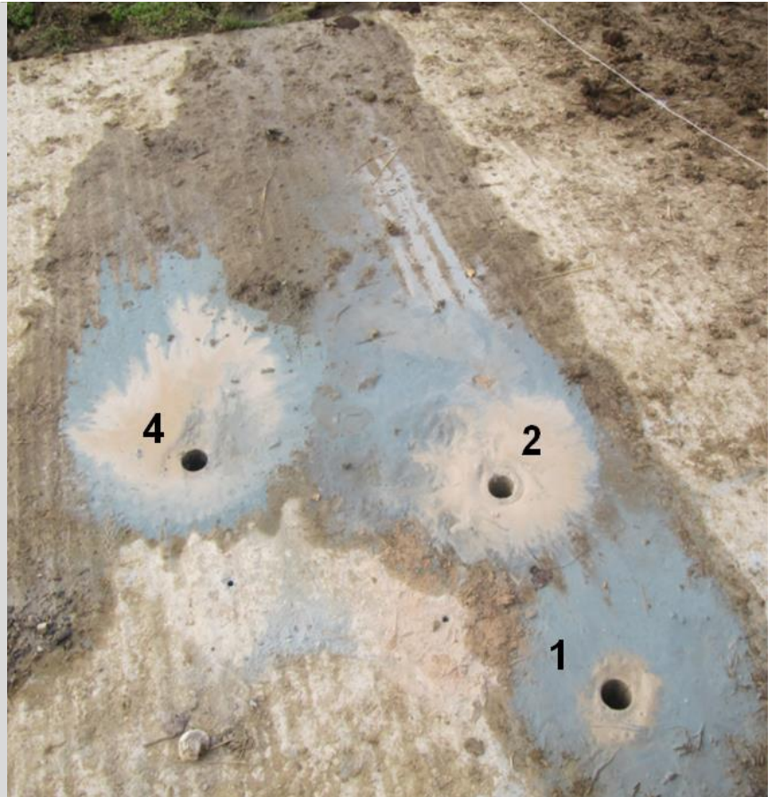
Henger minták kifúrása a betonlemezről
