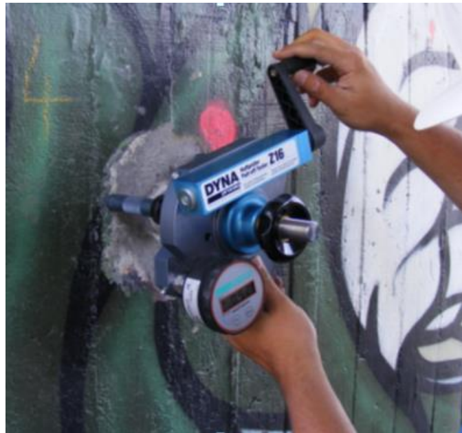
A betonszerkezetek tapadó szilárdságának meghatározása
