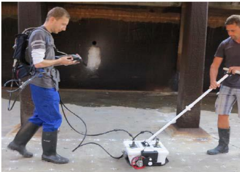
Radarvizsgálatok az alaplemezen és a oldalfalon
