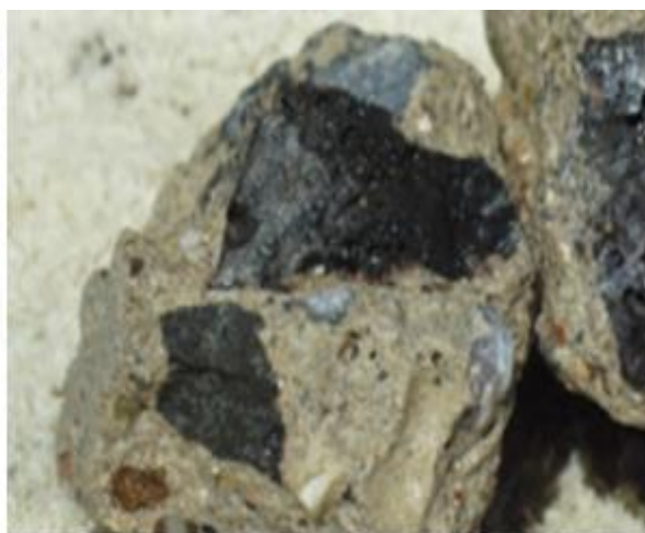
A martinsalak darabok a feltárt falszerkezet betonanyagában
