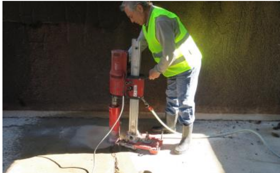
Hengerminták kifúrása az oldalfalból és az alaplemezéből
