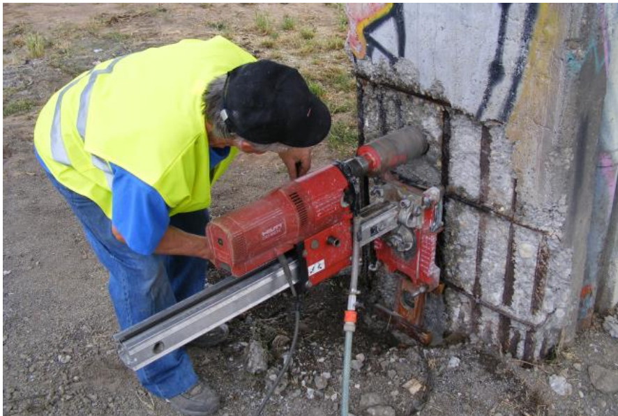
A alaptest feltárása és tartópillérek szilárdságvizsgálata
