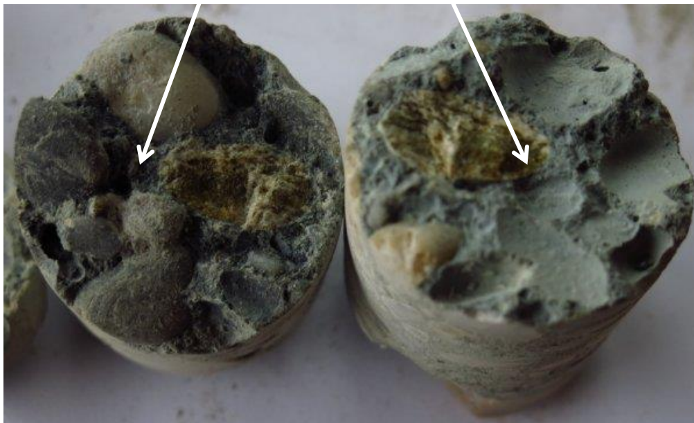
A Visnyei silótároló betonajzatából vett furatminta és töretfelülete
