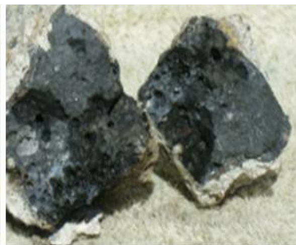
A martinsalak darabok a feltárt falszerkezet betonanyagában
