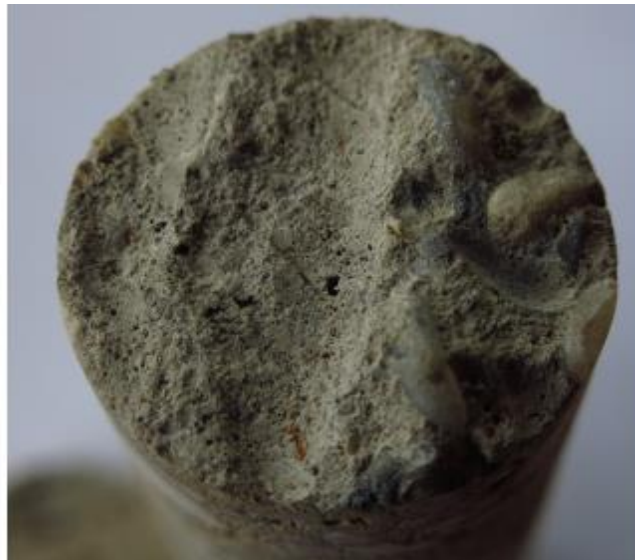
Nem megfelelő tapadás a betonacél és a beton között
