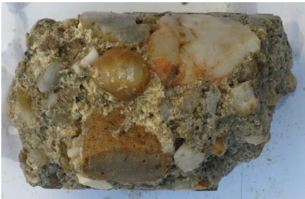
5. sz. A falból kifúrt szétmálló magminta egyben maradt darabja
