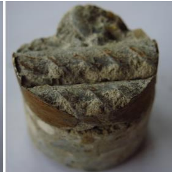
Nem megfelelő tapadás a betonacél és a beton között
