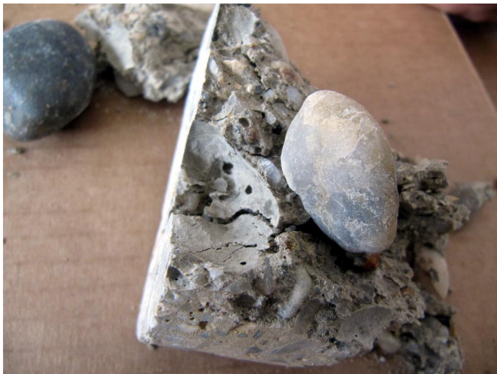
A betonaljzatból kifúrt hengerminta töretfelülete
