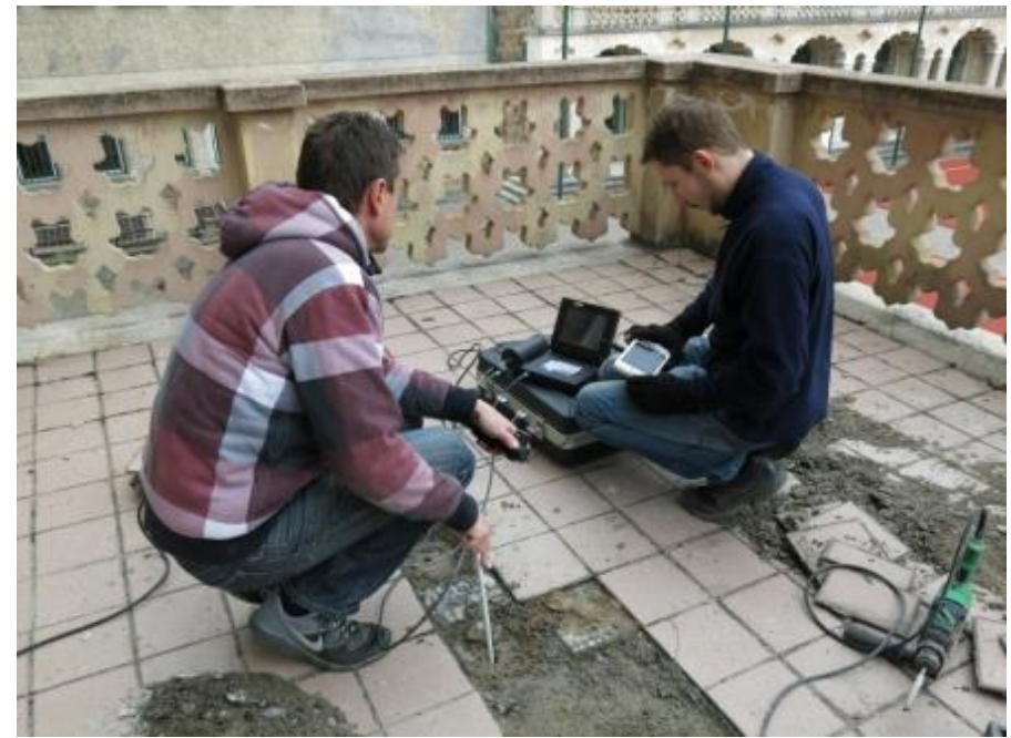
A bauxitbeton szerkezetek vizsgálata (mintavételezés és rétegrend)
