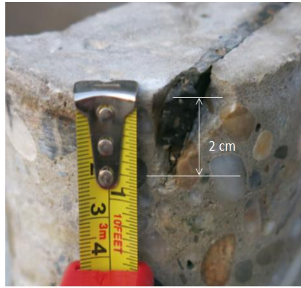
Zsugorodási (száradási) repedések és a fuga vizsgálata
