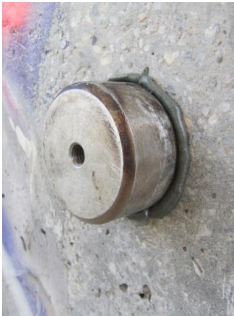
A betonszerkezetek tapadó szilárdságának meghatározása
