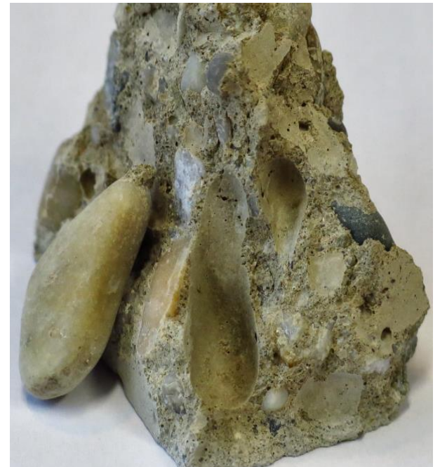
A beton töretképe a kavicsszemcsék lenyomataival
