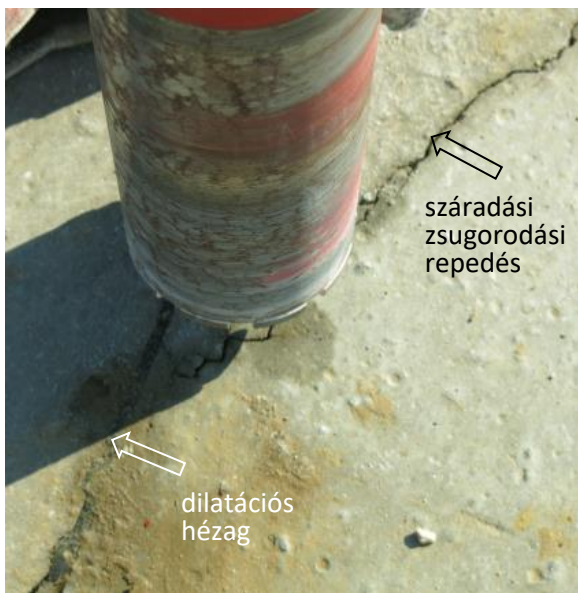
Zsugorodási (száradási) repedések és a fuga vizsgálata
