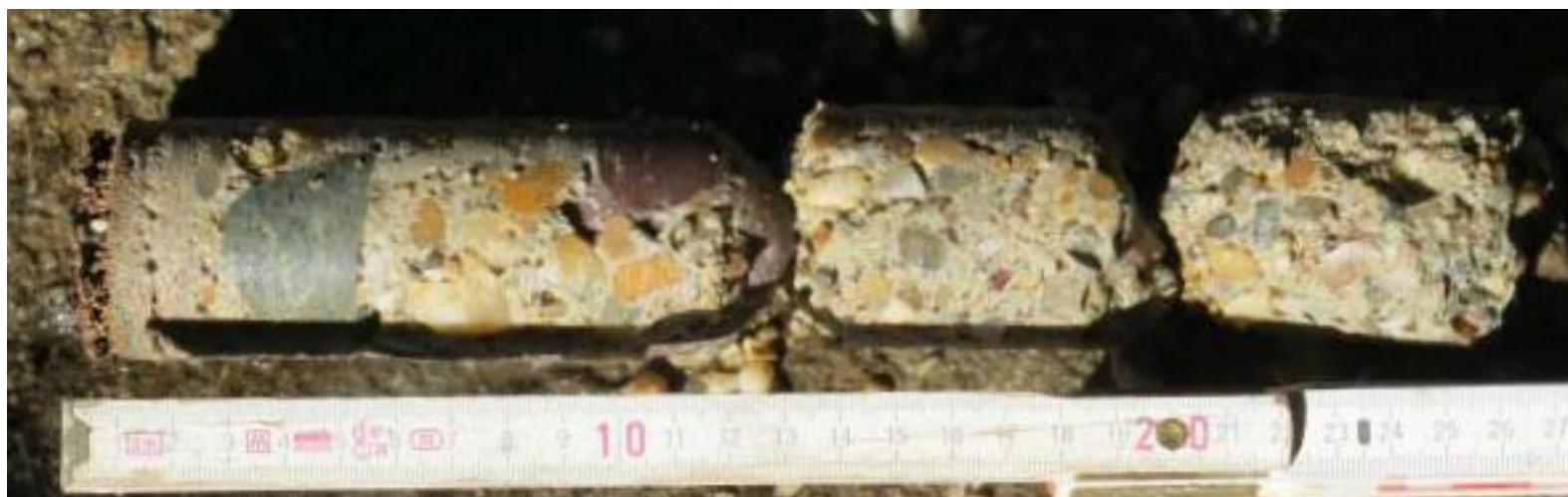
6. sz. A medence oldalfalából kifúrt töredezett magminta
