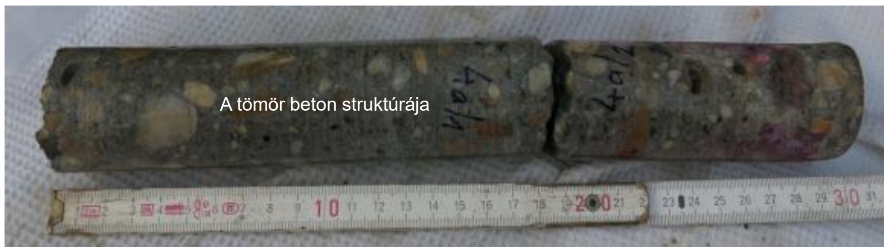
A vasbeton szerkezet betonanyagának vizsgálata.
