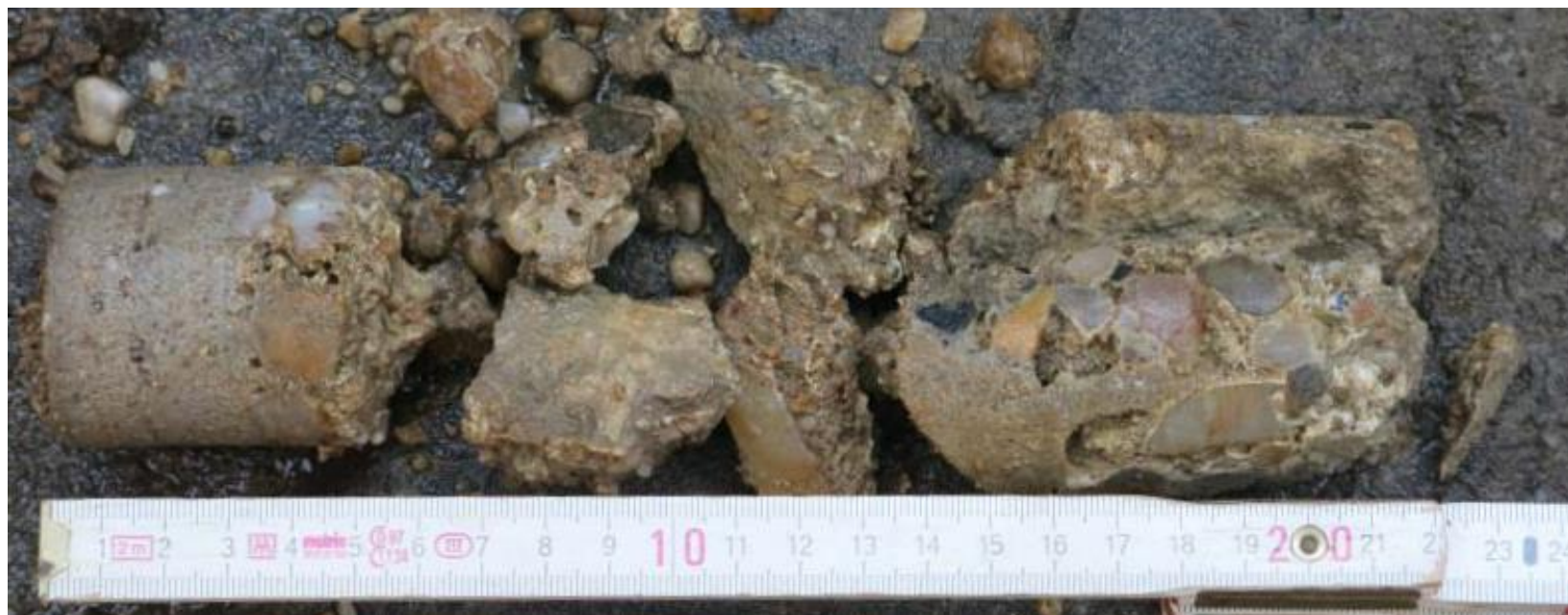
4. sz. A medence oldalfalából kifúrt töredezett magminta
