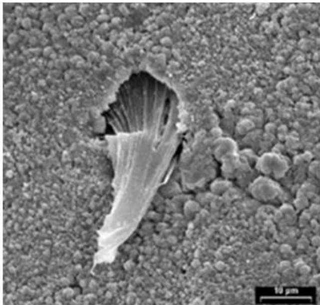
150 °C-on megolvadt polipropilén (PP) szál
