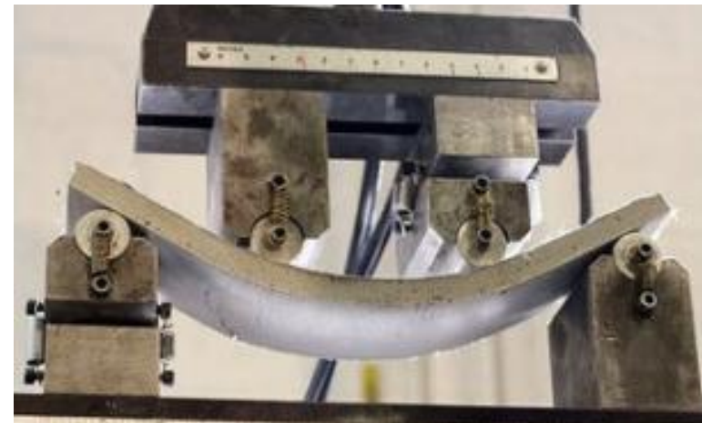
Betonelem hajlító vizsgálata
