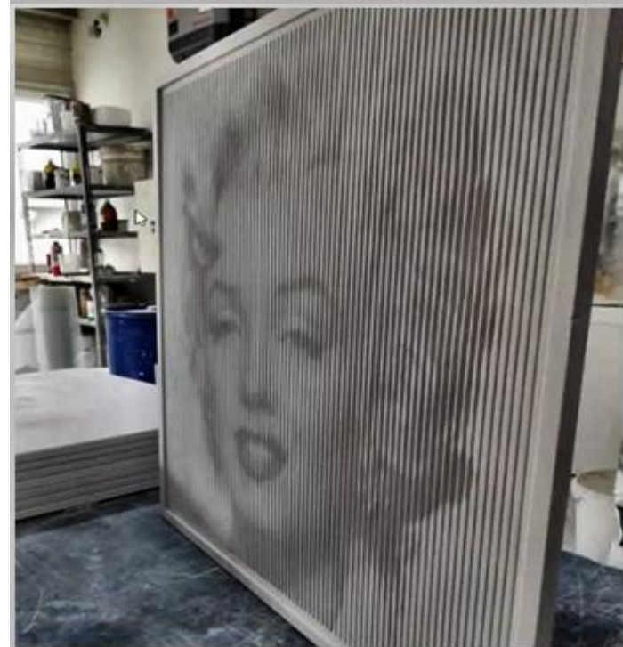
Mikro barázdás gumisablonban gyártott falpanelek
