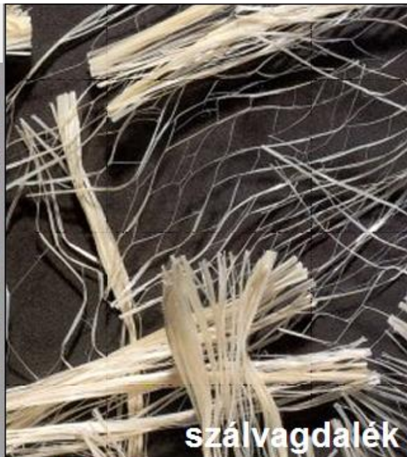
bikomponensű műa. makrószál
