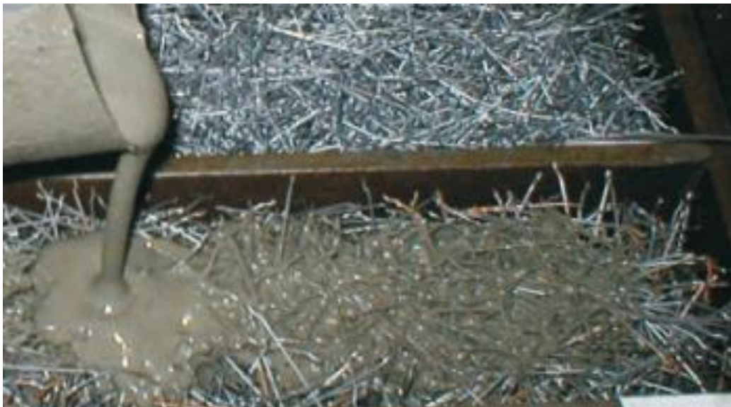
SIFCON beton (habarccsal kitöltött acélszálak)
