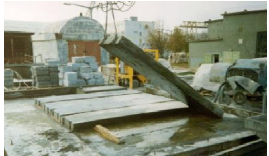
Habbeton falazó elemek gyártása
