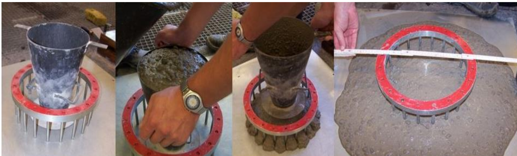
Az öntömörödő beton blokkoló gyűrűs vizsgálata
