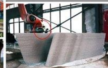
Gyalogos betonhid Shanghai (2019) Hossza: 26 m szélesség: 3,6 m Robot karos nyomtatással előregyártva. Helyszínen szerelve üreges elemekből.
