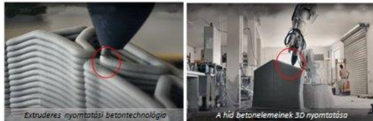
A híd betontömb elemeinek előgyártása, 3D nyomtatással.
