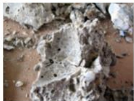
A betonaljzatból kifűrt hengerminta töretfelülete
