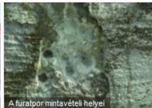
A korróziós károsodást szenvedett falszerkezet és vizsgálata
