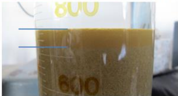
Az alkalmazott homokagyag-iszap tartalmának vizsgálata ( i = 6,4\% )
