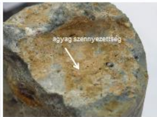
A fúrás közben széttöredezett hengerminta
