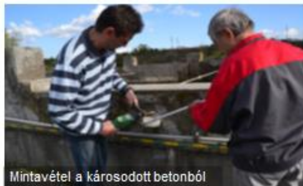
A korróziós károsodást szenvedett falszerkezet és vizsgálata
