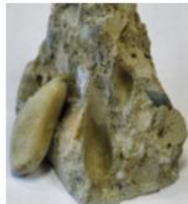
A beton töretképe a kavicszemcsék lenyomataival
