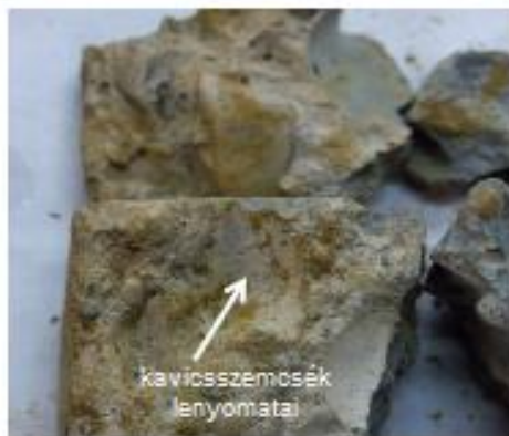
A fúrás közben széttöredezett hengerminta
