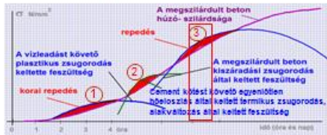
A beton kötése- és szilárdulása közötti zsugorodási jelenségek
