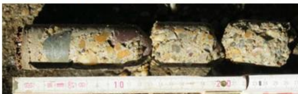
6. sz. A medence oldalfalából kifűrt töredezett magminta
