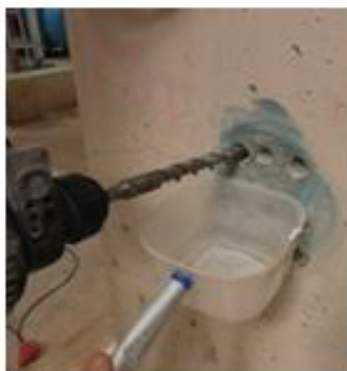
A beton pH értékének és a karbonátosodás mélységének meghatározása
