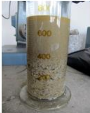
Az alkalmazott homokagyag-iszap tartalmának vizsgálata ( i = 6,4\% )
