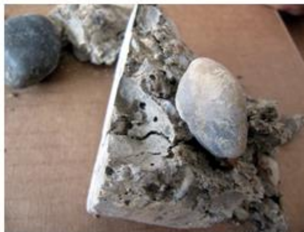
A betonaljzatból kifűrt hengerminta töretfelülete
