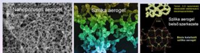
A nanostruktúrájú aerogel szerkezeti felépítése
