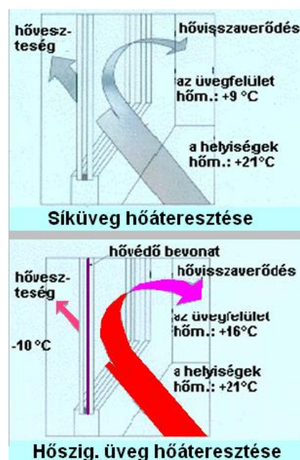
Hőszigetelő üveg működése
