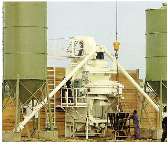
Forgódobos ellenáramú kényszerkeverőgép
