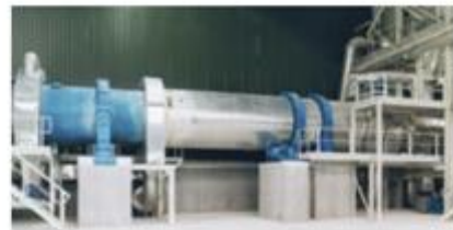
Építési gipsz előállítása forgókemencében
