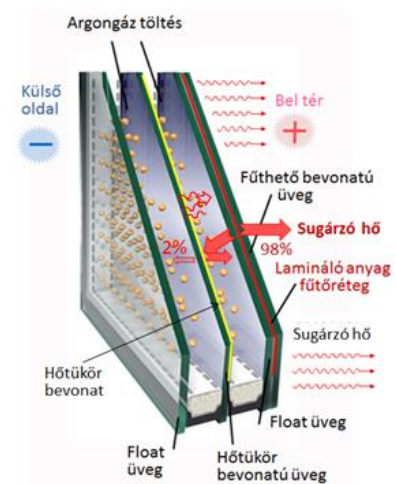
A hőszigetelő - fűtő üveg szerkezeti felépítése
