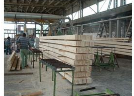
Ragasztott fatartók gyártása
