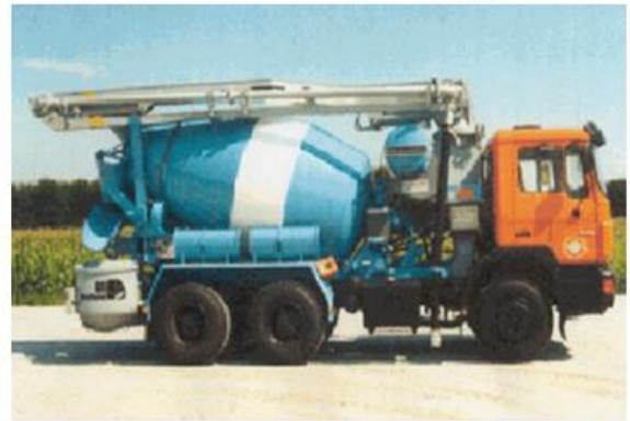
Mixer gépkocsi betonszivattyúval
