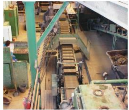
Vázkerámia béléstestek gyártása
