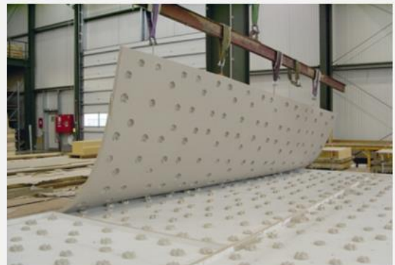
Virágok betonból. A PET palackok levágott fenéke sablonként szolgált
