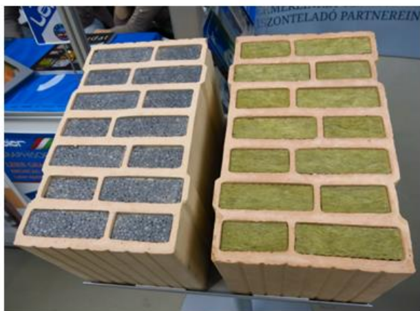
Cella üregek kitöltése (hőszigetelés)
