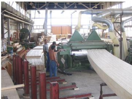
Íves szerkezetek kialakítása, kalodával
