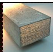
Litracon fényáteresztő beton
