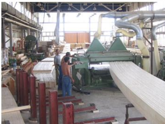
Íves szerkezetek kialakítása, kalodával
