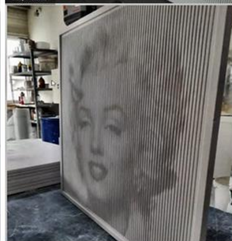
Mikro barázdás gumisablonban gyártott falpanelek
