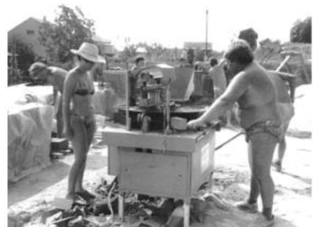
Téglagyártás prés géppel
