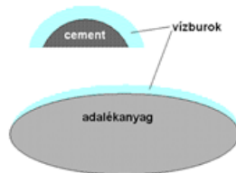
Vastag vízburrok a cement felületén
