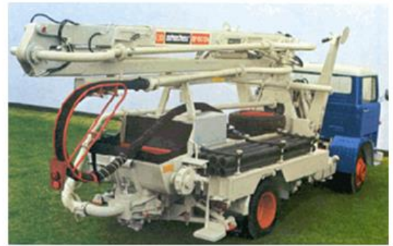
Autóra szerelt betonszivattyú
