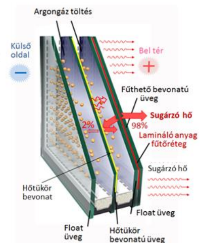
A hőszigetelő - fűtő üveg szerkezeti felépítése
