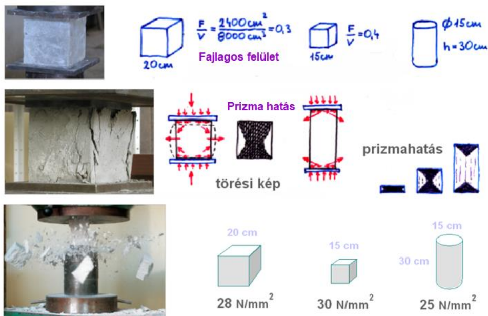
A próbatestek alakjának és méretének hatása a szilárdságra
