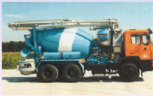
Autóra szerelt betonszivattyú
