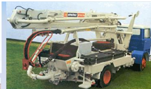
Autóra szerelt betonszivattyú
