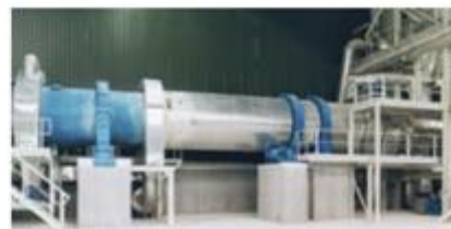
Építési gipsz előállítása forgókemencében
