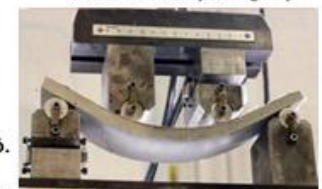
Betonelem hajlító vizsgálata
