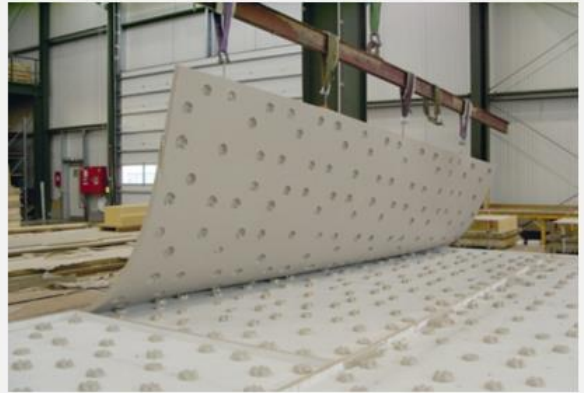
Virágok betonból. A PET palackok levágott feneke sablonként szolgált
