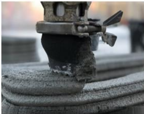
3D betonnyomtatás extruderes technológiával (nyomtatófej)
