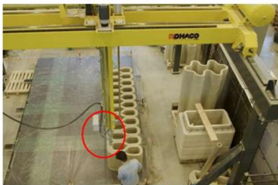
Hídlembek üzemi előnyomtatása
