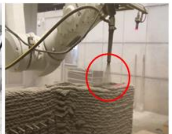
3D betonszerkezetek előállítás lött-betonos technológiával
