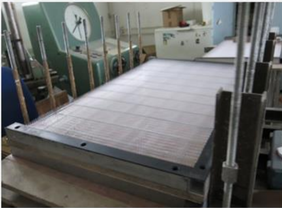
A pixelcsap panel összeszerelése a modulelemből
