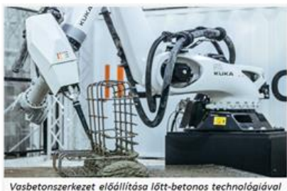
3D betonszerkezetek előállítás lött-betonos technológiával
