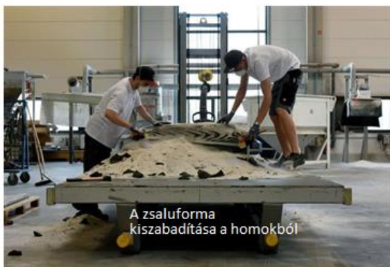
Födémlemez zsaluzatának előállítása 3D kötőanyag sugaras nyomtatóval
