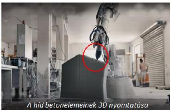
Habarc és betonacél erősítés nélküli hídszerkezet
