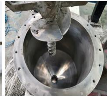
3D betonnyomtatás extruderes technológiával (nyomtatófej)
