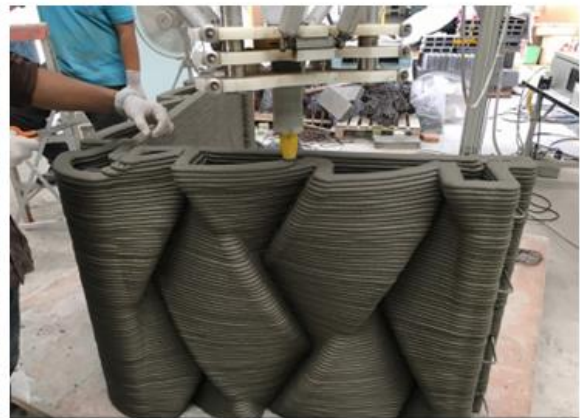
Agyag épület „Delta” rendszerű 3D nyomtatása, Olaszország (2018)
