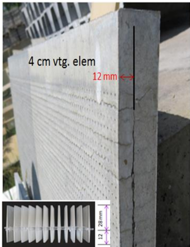
Repedések elhelyezkedése a pixelbeton termékekben
