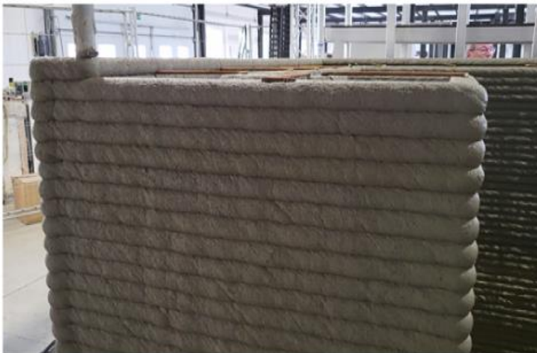
A falszerkezet nyomtatása (Turbotech, Szeged 2022)
