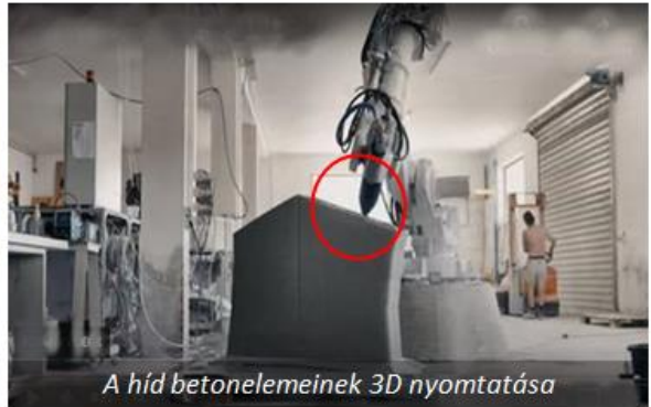
Habarc és betonacél erősítés nélküli hídszerkezet
