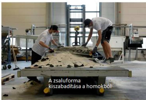
Födémlemez zsaluzatának előállítása 3D kötőanyag sugaras nyomtatóval
