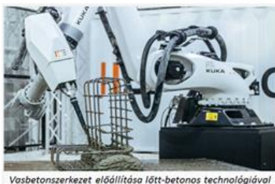
3D betonszerkezetek előállítása lőtt-betonos technológiával
