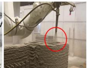
3D betonszerkezetek előállítása lőtt-betonos technológiával
