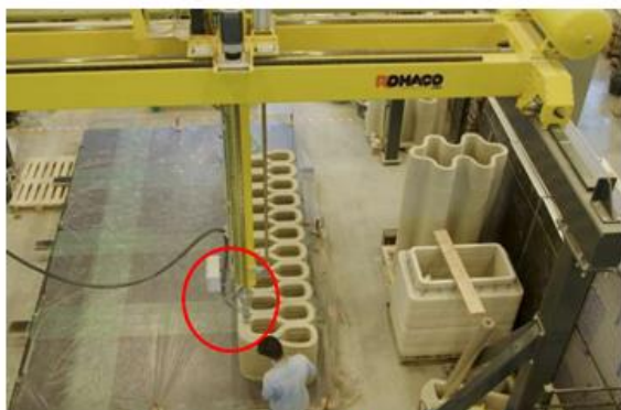
Hídelemek üzemi előnyomtatása
