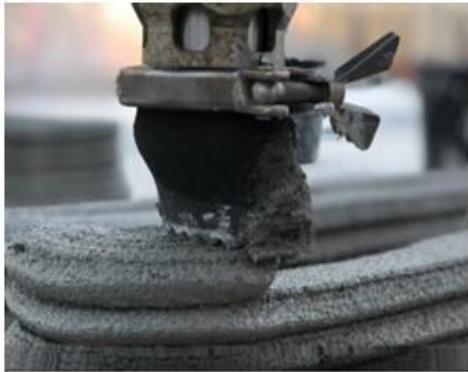
3D betonnyomtatás extruderes technológiával (nyomtatófej)
