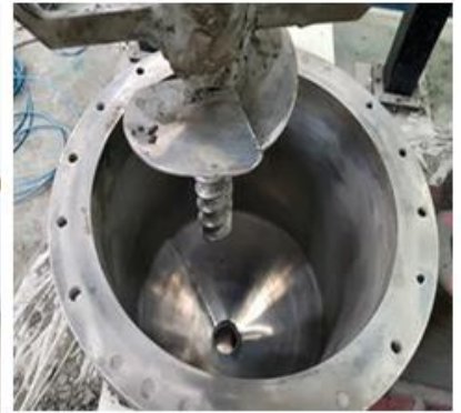
3D betonnyomtatás extruderes technológiával (nyomtatófej)
