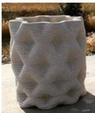
Robotkaros 3D technológiával nyomtatott kültéri bútorok
