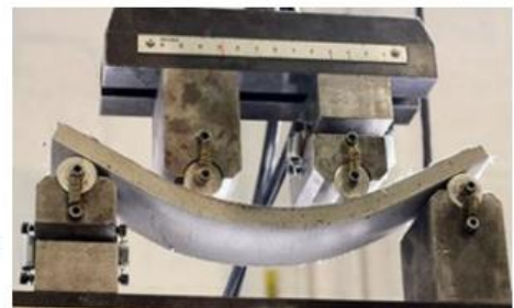
Betonelem hajlító vizsgálata
