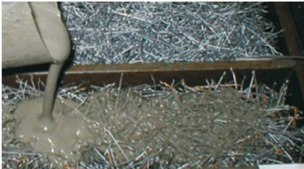
SIFCON beton (habarccsal kitöltött acélszálak)
