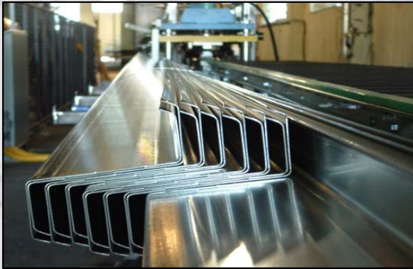
1. kép. Hidegen alakított Z szelvények [ www.metalucon.hu ]
