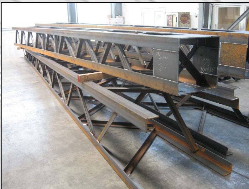
14. kép. Vasúti felsővezeték tartó oszlopok kialakítása térbeli rácsos tartóból
