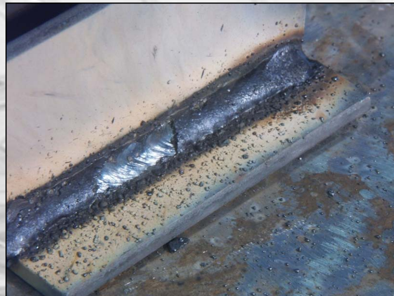
4. kép. Fröcskölés a túl nagy áramerősség miatt, utólagos tisztítást igényel
