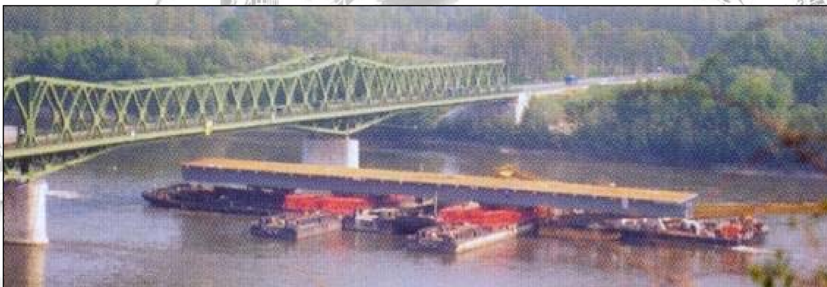
33-34. kép. A szekszárdi Szent László híd elemeinek szállítása a Dunán [Iványi M. 2008]
