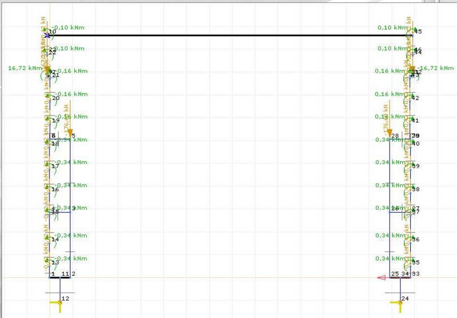
41. ábra. Keretállás modellje III. – leadódó önsúly
