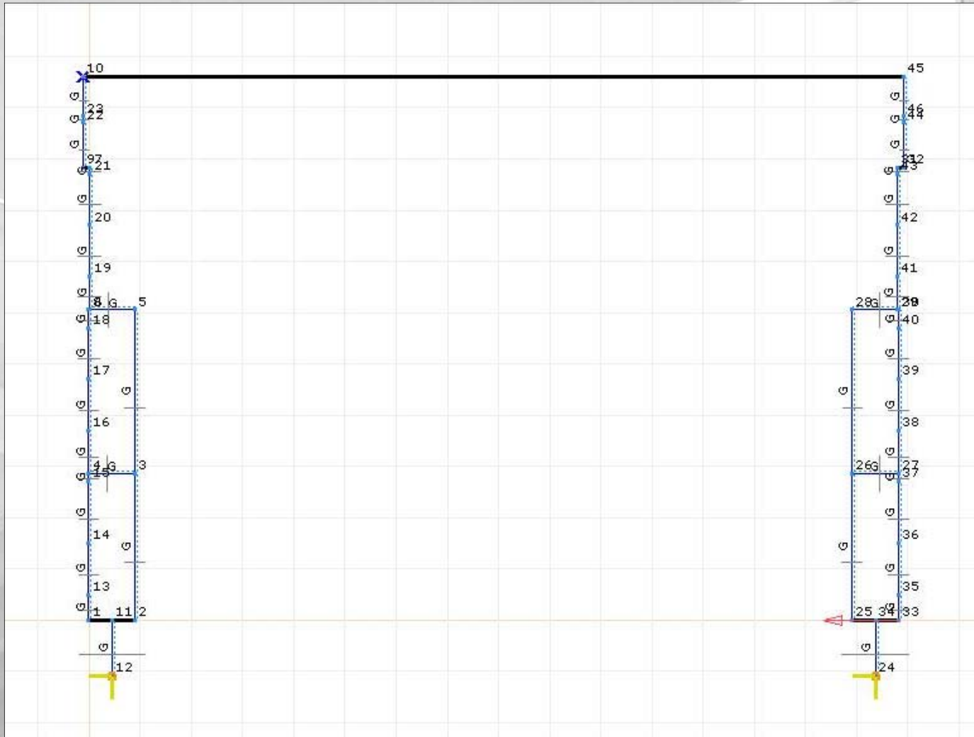
40. ábra. Keretállás modellje II. - önsúly
