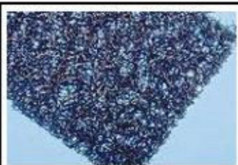
geoszálból préselt geoszőnyeg
