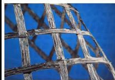
pásmákból hegesztett georács
