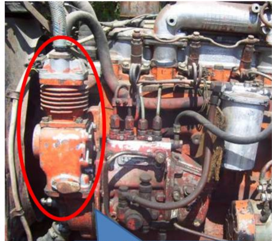
Belsőégésű motorral hajtott dugattyús kompresszor (MTZ)
