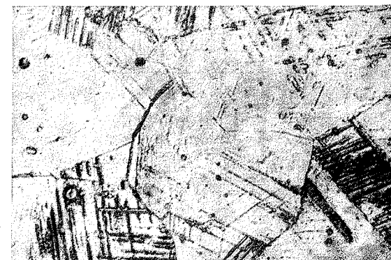
48. ábra. 18% Cr-, 8% Ni-tartalmú krómnikkel acél austenit szemcséiben hideg alakításkor keletkezett csúszásvonalak. Maratás: sósavas vas-klorid. Nagyítás: 500 : 1
