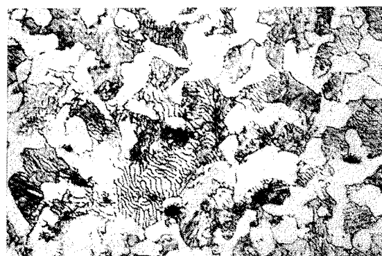
111. ábra. A 0,4% C-tartalmú ötvöztelen acél szövete: ferrit és perlit. 3% HNO 3 , 500 : 1
