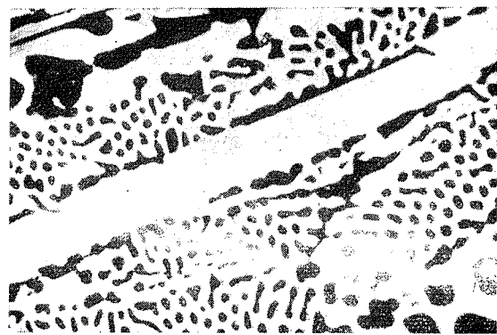
77. ábra. 5,5% C-tartalmú nyersvas szövete képe: ledeburit és primer cementit (fehér csik). 3% HNO 3 , 500:1
