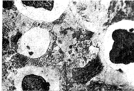
141. ábra. Gömbgrafitos öntvény szövetképe. A spherulitos grafitot ferrit szegélyezi. Szürke szövet: perlit. 3% HNO 3 , 300 : 1
