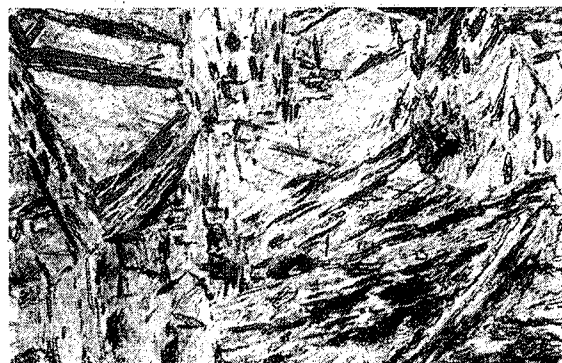
115. ábra. 0,5% C-tartalmú sínacél M_s felett (kb. 300 °C-on) átalakult bainites szövete. 2% HNO_3 , 500 : 1
