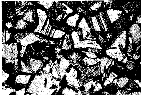
148. ábra. 67% Cu-tartalmú sárgaréz (Sr 67) szövete képe. Ikerkristályokat tartalmazó szemcsék: \alpha ; a határokon levő fekete csíkok: \beta' ; marószert 5 g vasklorid, 26 cm 3 sósav, 10 cm 3 víz, 200 : 1
