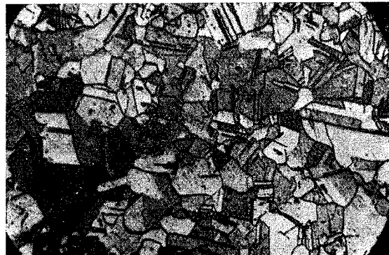
149. ábra. Sr 67 homogén \alpha -ból álló szövete (550 °C-on való izzítás után). Marószert: 5 g vasklorid, 26 cm 3 sósav, 100 cm 3 víz, 200 : 1
