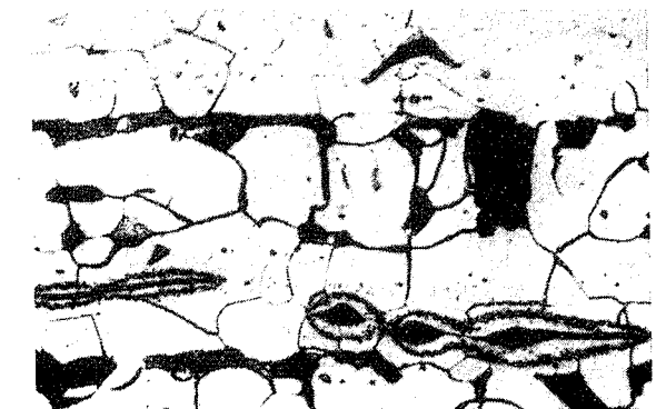
133. ábra. Salaksor mint csíra a proeutektoidos ferrit számára lágy acélban. 3% HNO_3 , 500 : 1
