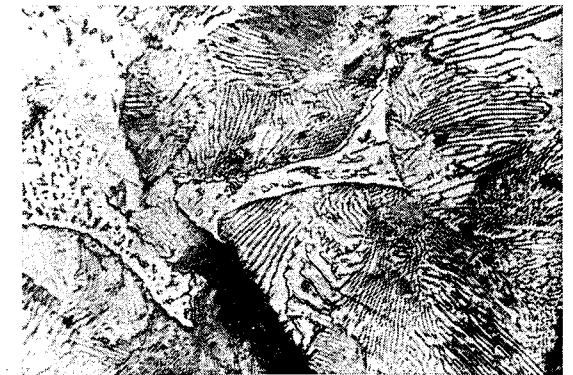
136. ábra. Steadit: vas — vaskarbid — vasfoszfid eutektikum a szürkevasban. Homorú határú pettyes szövetelem. 3% HNO 3 , 500 : 1
