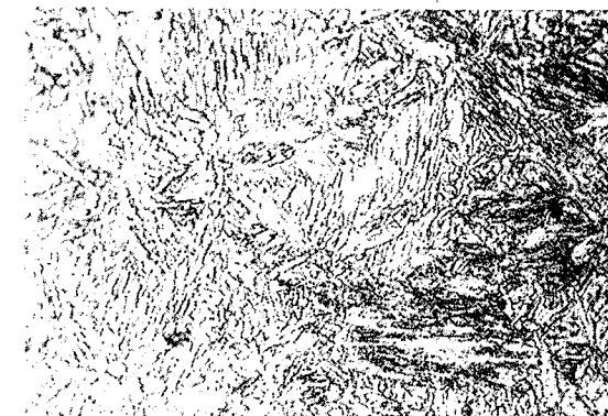
114. ábra. 0,5% C-tartalmú sínacél felső hőmérséklet-határ alatt (kb. 500 °C) átalakult bainites szövete. 2% HNO 3 , 500 : 1
