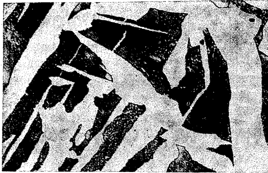
182. ábra. 0,26% C-tartalmú acélöntvény primer szövete: durva Widmannstätten-szövet. 3% HNO 3 , 200 : 1. \sigma_B = 43,7 \text{ kp/mm}^2 , \delta_5 = 13,1\% , \psi = 14,2\% , a_k = 2,9 \text{ mkp/cm}^2
