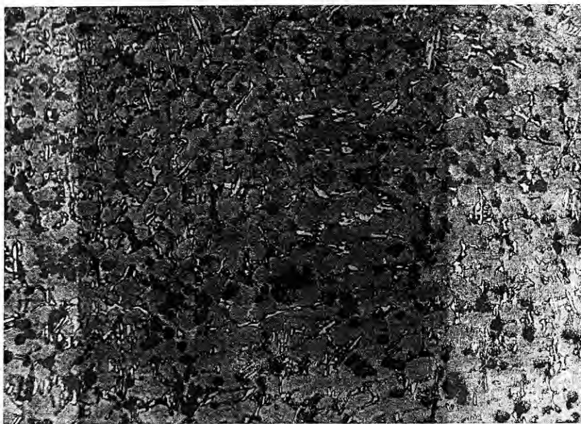
48. ábra. Öntvényfelületre felvitt első varrat szövetszerkezete tömörítés nélkül; cementites rideg szövet
