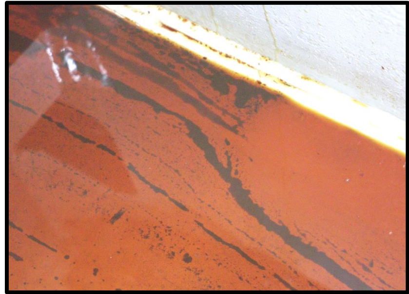
Hajtóműház: oxidálódott olajsár
