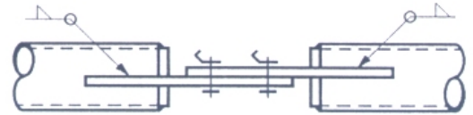
d) Hasításban elhelyezett kétoldali hevederlemez illesztés
