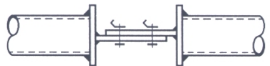
c) Hasításban elhelyezett egyoldali hevederlemez illesztés
