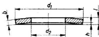
10. táblázat. A szabványos tányérrugók méretei és az azokhoz tartozó rugóerő, valamint a rugózás útja
