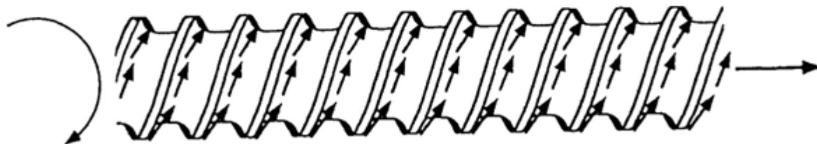
kis menetemelkedésű csiga disztributív keveréshez
