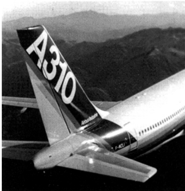
14.25 ábra: Az AIRBUS–310 repülőgép polimer kompozitból készült függőleges vezérsíkja [14.13]
