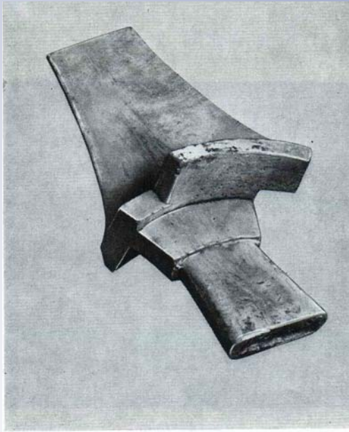
8-19. ábra. Fémkokillába öntött METAMID ventilátorlapát
