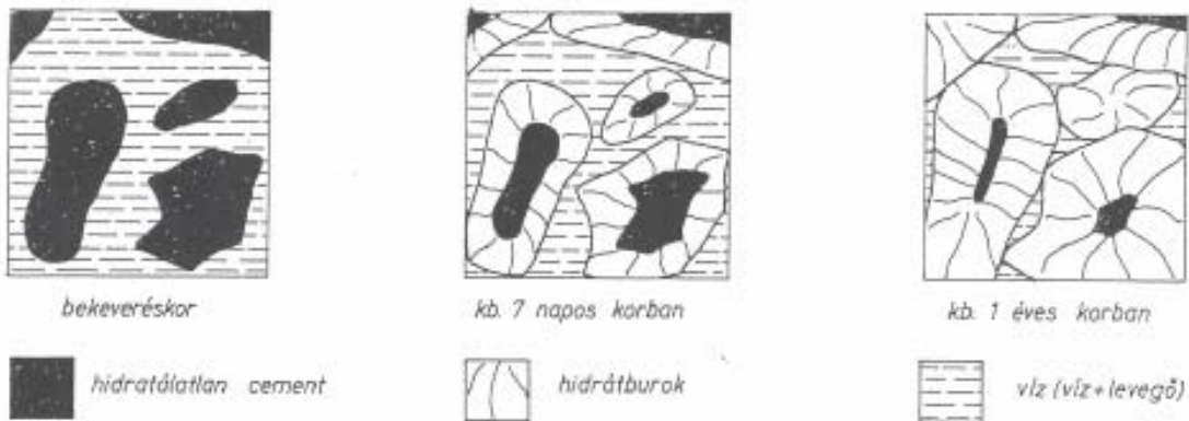
61. ábra Hidráttermékek kialakulása a cement kötése és szilárdulása során [6]
