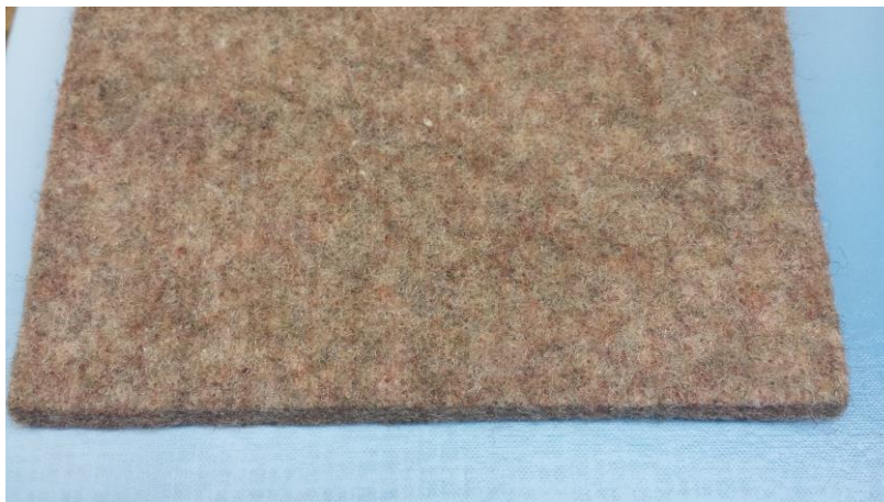
74. ábra: Geotextil (1200 g/m 2 )
