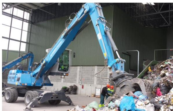
55. ábra: Emelhető fülkés ipari gémes rakodógép
