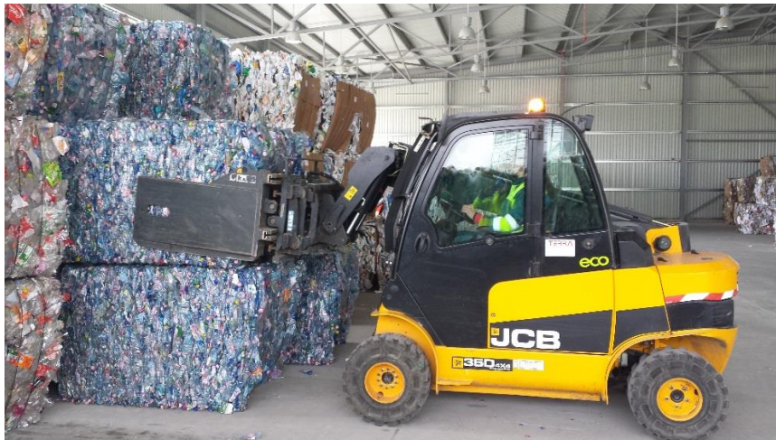
30. ábra: Kitológémes, magas emelésű targonca bálafező adapterrel
