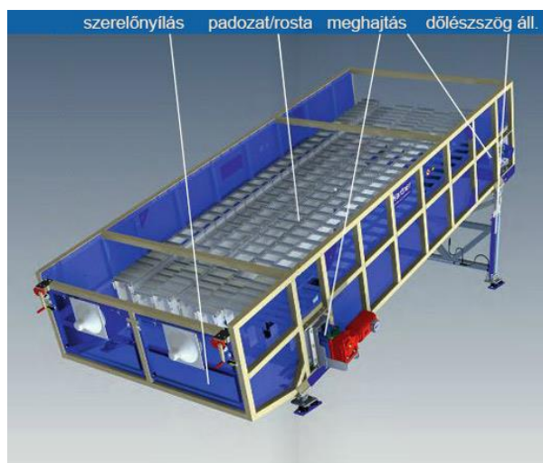
48. ábra: Ballisztikus szeparátor (Forrás: Best Machinery Kft.)
