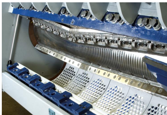
51. ábra: Utóaprító-gép rotorja és rostafelülete (Forrás: Lindner GmbH)
