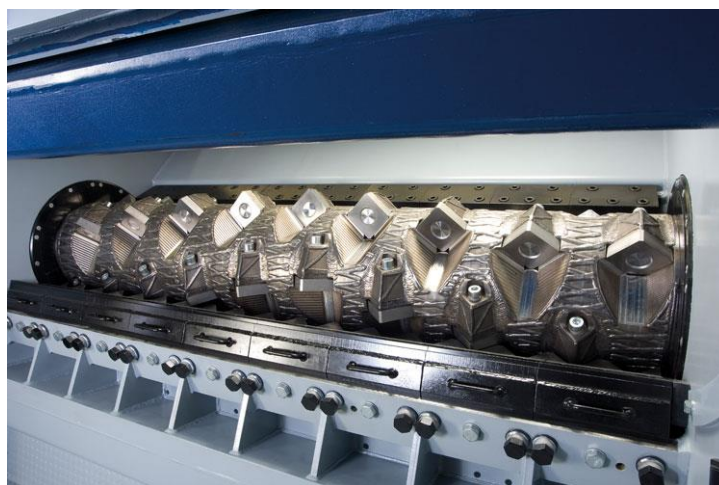
43. ábra: Marórotoros aprítógép rotorja (Lindner GmbH)
