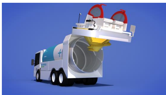
12. ábra: Forgódobos gyűjtőautó felemelt hátfallal (Forrás: http://www.bobc3d.com )
