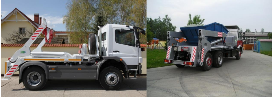
13. ábra: Kétkaros konténerszállító járművek (Forrás: Seres Kft)
