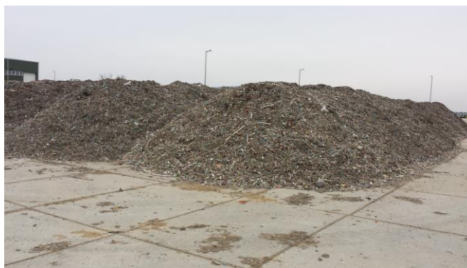
56. ábra: Magas szerves anyag tartalmú hulladék nyílttéri utósztabilizálása
