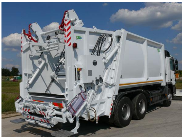
11. ábra: Tömörítőlapos gyűjtőautó (Forrás: Seres Kft)
