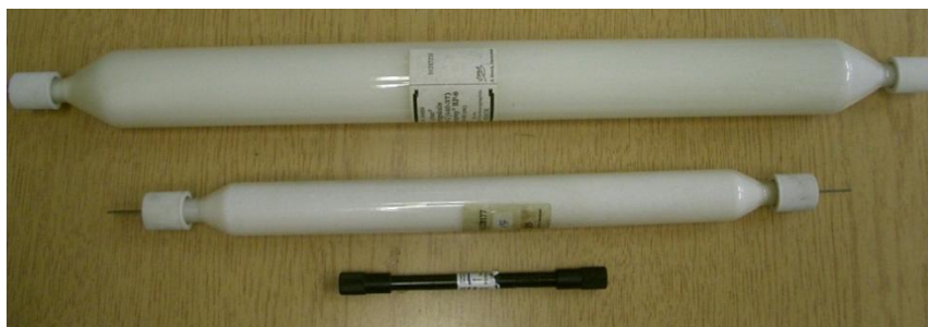
2.2.5.9. ábra. Analitikai HPLC-oszlop (fekete) és két preparatív (kis nyomású, üvegfalú) kromatográfias oszlop
