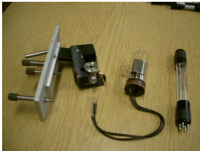
2.2.5.8. ábra. Spektrofotometriás HPLC detektorhoz való fényforrások, valamint átfolyó kivetta a küvettatartó (fekete) és pozicionáló (szürke) szerkezetben
