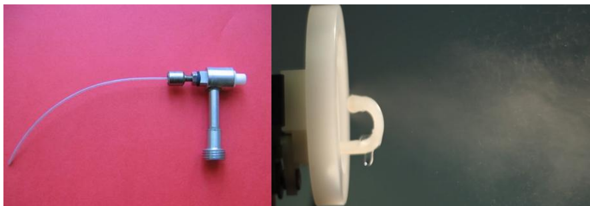
2.1.7.4. ábra. Atomabszorpciós készülék porlasztója és primer aeroszol
