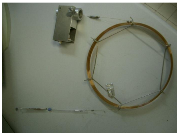
2.2.5.3. ábra. A gázkromatográfias rendszer részegységei egymás mellé fektetve abban az elrendezésben, ahogy majd összekötésre kerülnek:
