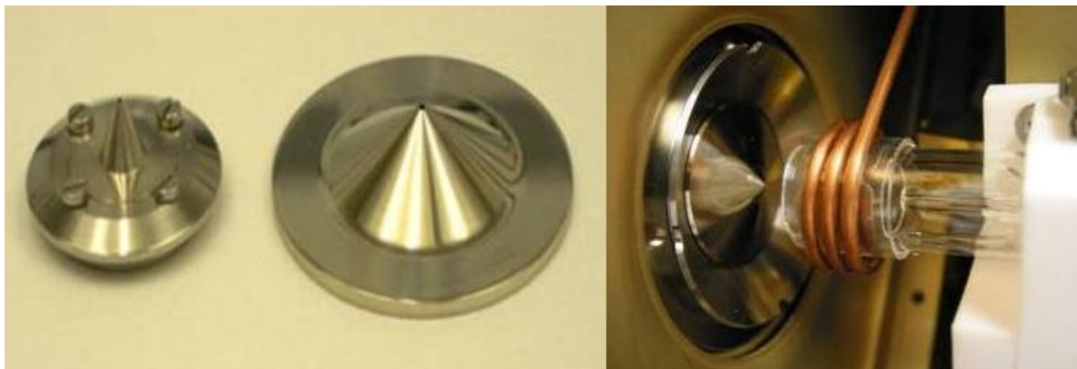
2.6.2.3. ábra. Nikkeltónusok. A plazmaégő a mintavevő kónusz előtt
