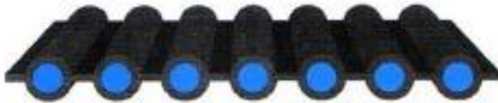
Lefedés nélküli síkkollektor, abszorber
